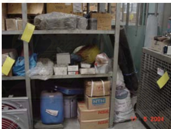
รูปที่ 4.3 การจัดวางในบางส่วนของชั้นวางวัสดุไม่เป็นระเบียบและไม่แสดงสถานะชิ้นส่วน
