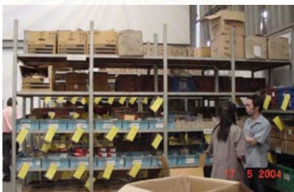
รูปที่ 4.5 การจัดวางชิ้นส่วนในกระบอกอย่างเป็นสัดส่วน มีป้ายชื่อและ Stock Card แต่การใช้พื้นที่ในการวางไม่เต็มประสิทธิภาพ คือจะมีพื้นที่ว่างอยู่ที่ชั้นที่ 3 ที่สามารถจะวางได้
