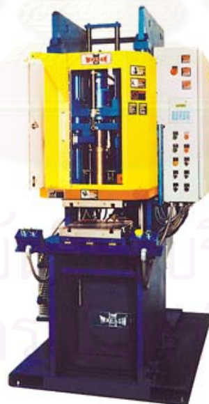
รูปที่ 3.20 ตัวอย่างเครื่องจักรในกระบวนการ compression molding (ที่ปรึกษาตรวจสอบ จุฬาลงกรณ์มหาวิทยาลัย, 2549)
