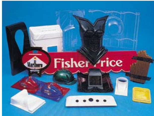
รูปที่ 3.42 ตัวอย่างผลิตภัณฑ์ที่ได้จากกระบวนการ thermoforming (ที่ปริกษาตรวจสอบ จุฬาลงกรณ์มหาวิทยาลัย, 2549)
