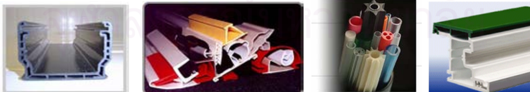
รูปที่ 3.33 ตัวอย่างผลิตภัณฑ์ที่ได้จากกระบวนการ profile extrusion (ที่ปรึกษาตรวจสอบ จุฬาลงกรณ์มหาวิทยาลัย, 2549)
