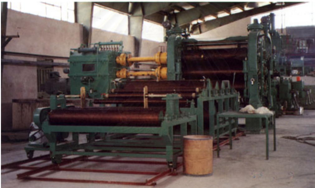
รูปที่ 3.40 ตัวอย่างเครื่องจักรในกระบวนการ calendaring
