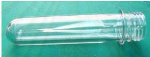
รูปที่ 3.10 รูปร่างของ Preform ที่ได้จากการฉีดพลาสติกชนิด PET (ที่ปรึกษาตรวจสอบ จุฬาลงกรณ์มหาวิทยาลัย, 2549)
