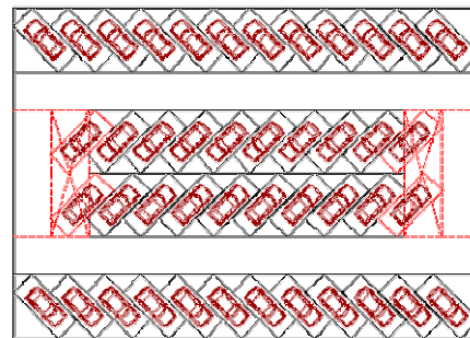
ภาพที่ 3.19 แสดงการนำทางลาดไปวางในอาคารจอดรถยนต์ที่เป็นทางเดินรถยนต์แบบเดินรถทางเดียว
