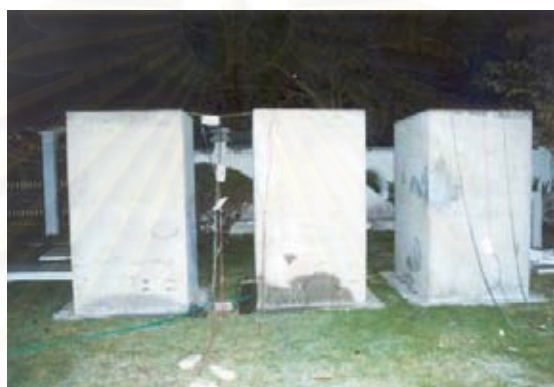
รูปที่ 3.7 แสดงสภาพบ่อทดลอง และการติดตั้งสายสัญญาณ สำหรับชุดที่ 2 - 3
