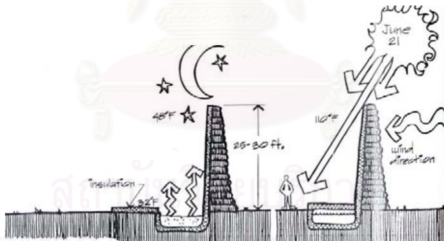
รูปที่ 2.13 แสดงพฤติกรรมของ ICE WALLS ที่มา Natural Solar Architecture : The Passive Solar Primer. 3 RD Ed. ของ David Write. น. 212
