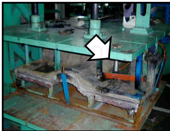
รูปที่ 5.13 : แสดงการติดตั้งอุปกรณ์เจาะรูอ้างอิงขณะขึ้นรูปในแม่พิมพ์
