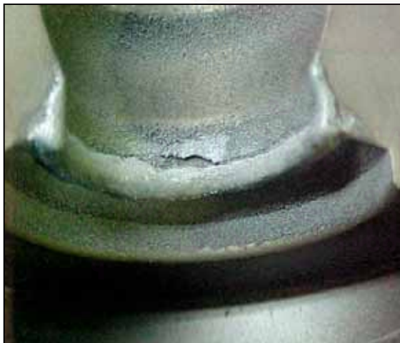
รูปที่ 4.55 แสดงให้เห็นรอยเชื่อมที่ทำการเชื่อมซ่อม และรูปที่ทำการถลุงใหม่แล้ว
