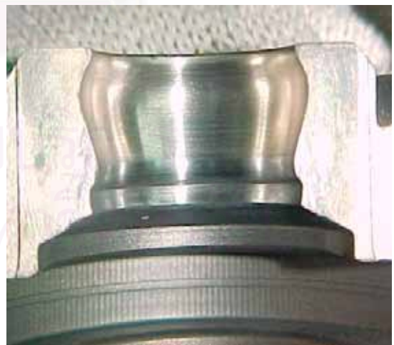
รูปที่ 4.55 แสดงให้เห็นรอยเชื่อมที่ทำการเชื่อมซ่อม และรูปที่ทำการถลุงใหม่แล้ว
