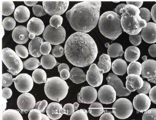
รูปที่ 4.6 แสดงรูปร่างและพื้นผิวของผงเชื่อม C (No.225) ที่กำลังขยาย 450 เท่า
