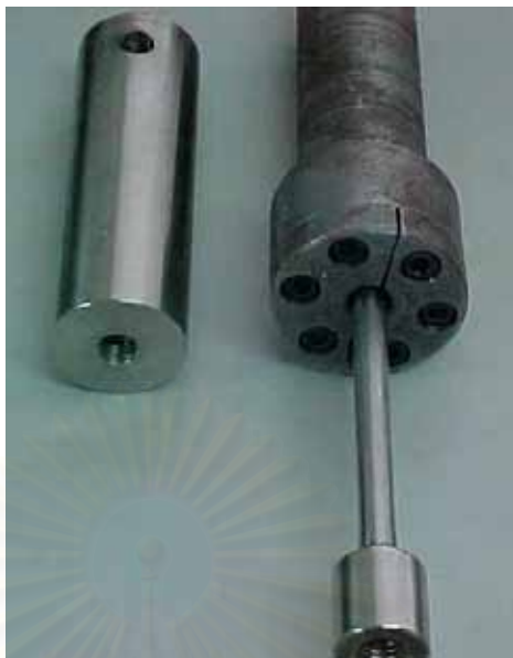
รูป 3.7 แสดง ชุดจับชิ้นงานเชื่อมสำหรับทดสอบค่าทนแรงดึง ที่ออกแบบมาใหม่
