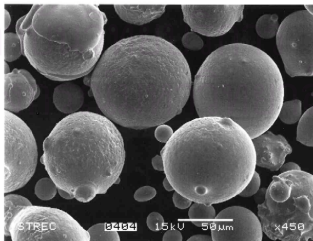
รูปที่ 4.4 แสดงรูปร่างและพื้นผิวของผงเชื่อม B (No.24) ที่กำลังขยาย 450 เท่า
