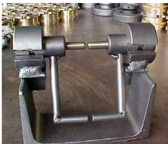
รูปที่ 3.3 แสดง ชุดจับชิ้นงานเชื่อมทดสอบ
