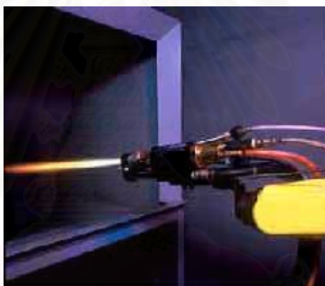
รูปที่ 2.3 แสดงการเชื่อมแบบเชื่อมโลหะผง (Powder Spraying)
