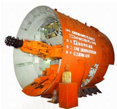
รูปที่ 3.1 Open-Face TBM ( http://www.hitachi-c-m.com )
