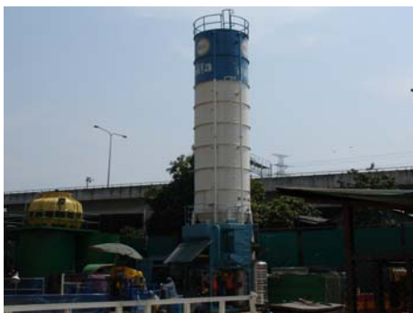
รูปที่ 3.13 โรงงานสำหรับใช้ผลิตวัสดุชุดของว่างรอบดาตผนังอุโมงค์ (สำนักการระบายน้ำ, 2548)
