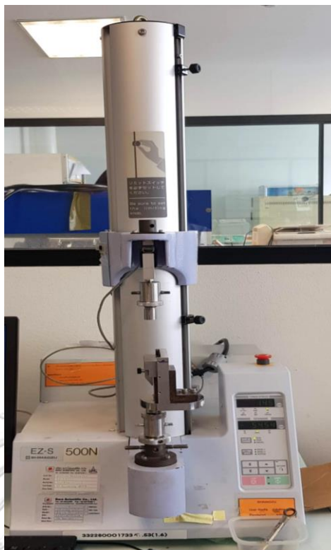
รูปที่ 10 แสดงเครื่องทดสอบแรงแบบอเนกประสงค์
