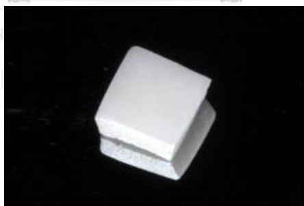
รูปที่ 5 ชิ้นงานเซอโรโคเนียที่ผ่านเผาขึ้นเทอร์
