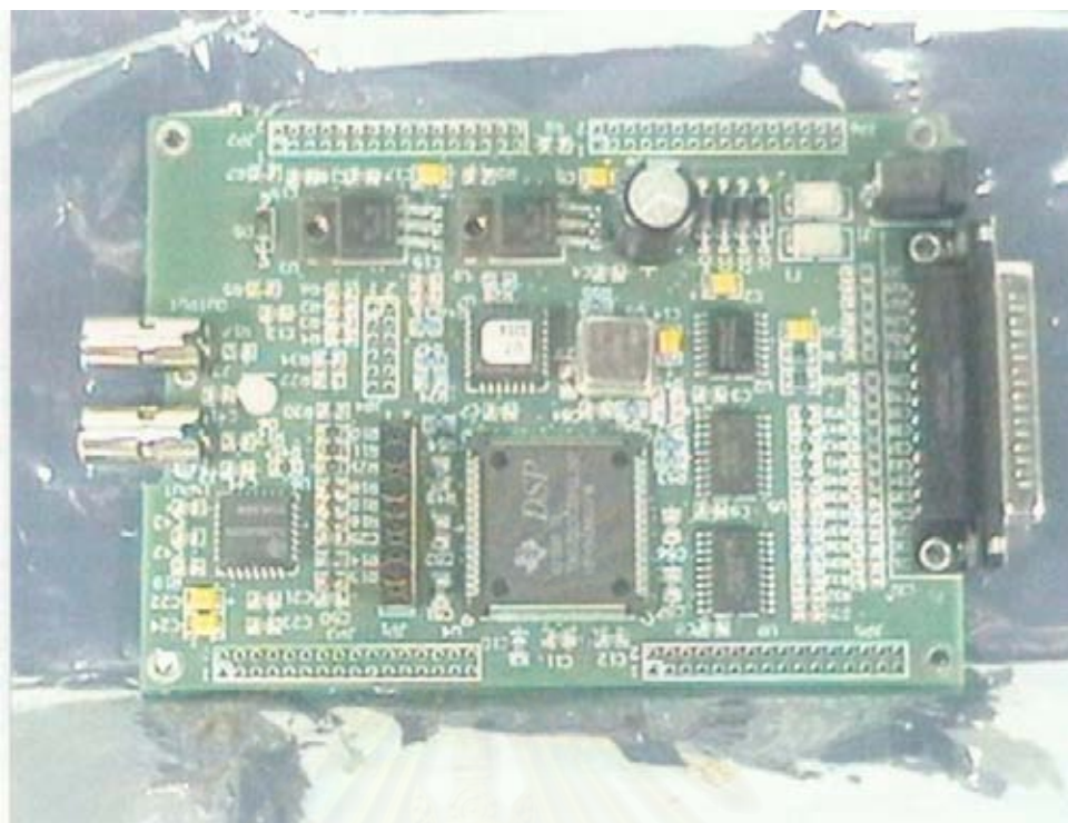
รูปที่ 4-10 ค ตัวประมวลผลสัญญาณเชิงดิจิทัลรุ่น TMS320c31 DSK
