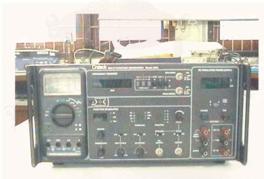
รูปที่ 4-7 เครื่องกำเนิดสัญญาณ (Signal Generator) ของบริษัท Crotech รุ่น 4950
