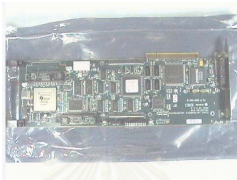
รูปที่ 4-11 ข ชุดควบคุมที่ใช้ในการทดลอง รุ่น TMS320c6701 EVM ประกอบไปด้วย DSP chip ตัวแปลงสัญญาณ A/D D/A หน่วยความจำ พอร์ตเชื่อมต่อกับคอมพิวเตอร์
