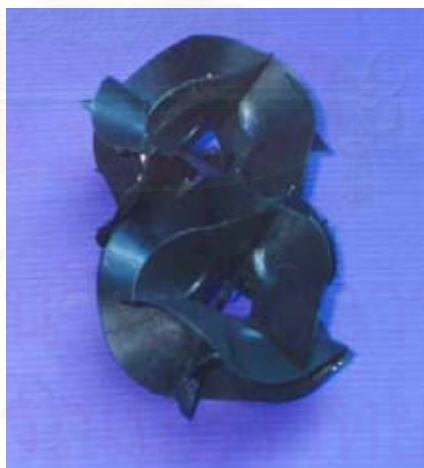
รูปที่ 3.1 ตัวกลางพลาสติกโพลีเอทิลีนที่ใช้ในการวิจัย
