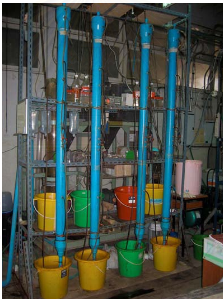
รูปที่ 4.19 การติดตั้งอุปกรณ์ของระบบบำบัดแอนแอโรบิกไฮบริดฟิลเตอร์ที่มีถังหมักกรดนำ
