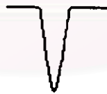
รูปที่ 3.22 แสดงสัญญาณเอ็นเอ็มอาร์ที่ออกจากโรบินสันดีเทคเตอร์
