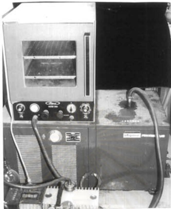
รูปที่ ๑.๘ ตู้สูญญากาศที่ใช้กำจัดฟองอากาศออกจากสารละลายพอลิเมอร์
