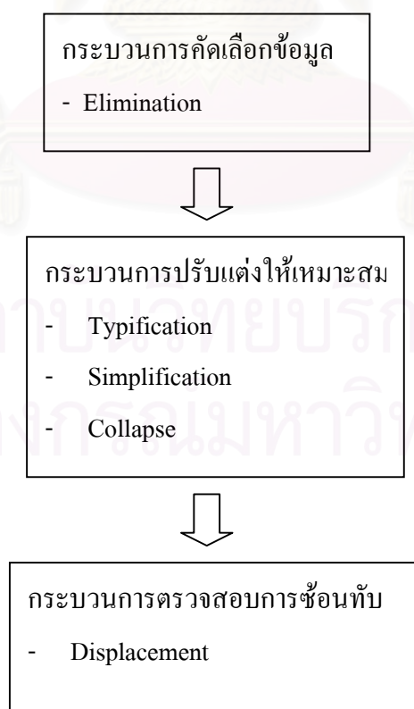
รูปที่ 2.11 แสดงแผนผังกระบวนการและขั้นตอนการทำงานเจนเนอราลไลซ์ ที่ผู้วิจัยเลือกศึกษา
