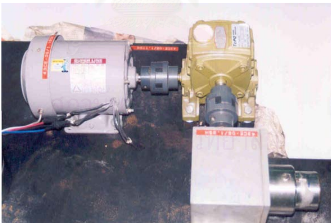
รูปที่ 3.8 ชุดมอเตอร์สำหรับทดสอบหาแรงเสียดทานที่ผิวสัมผัส
