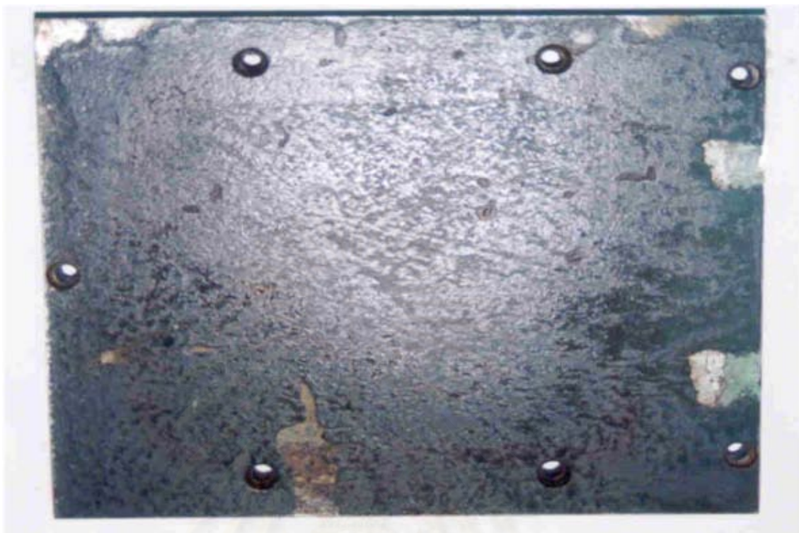
รูปที่ 3.3 แผ่นเหล็กผิวหยาบที่ใช้ในการทดสอบ
