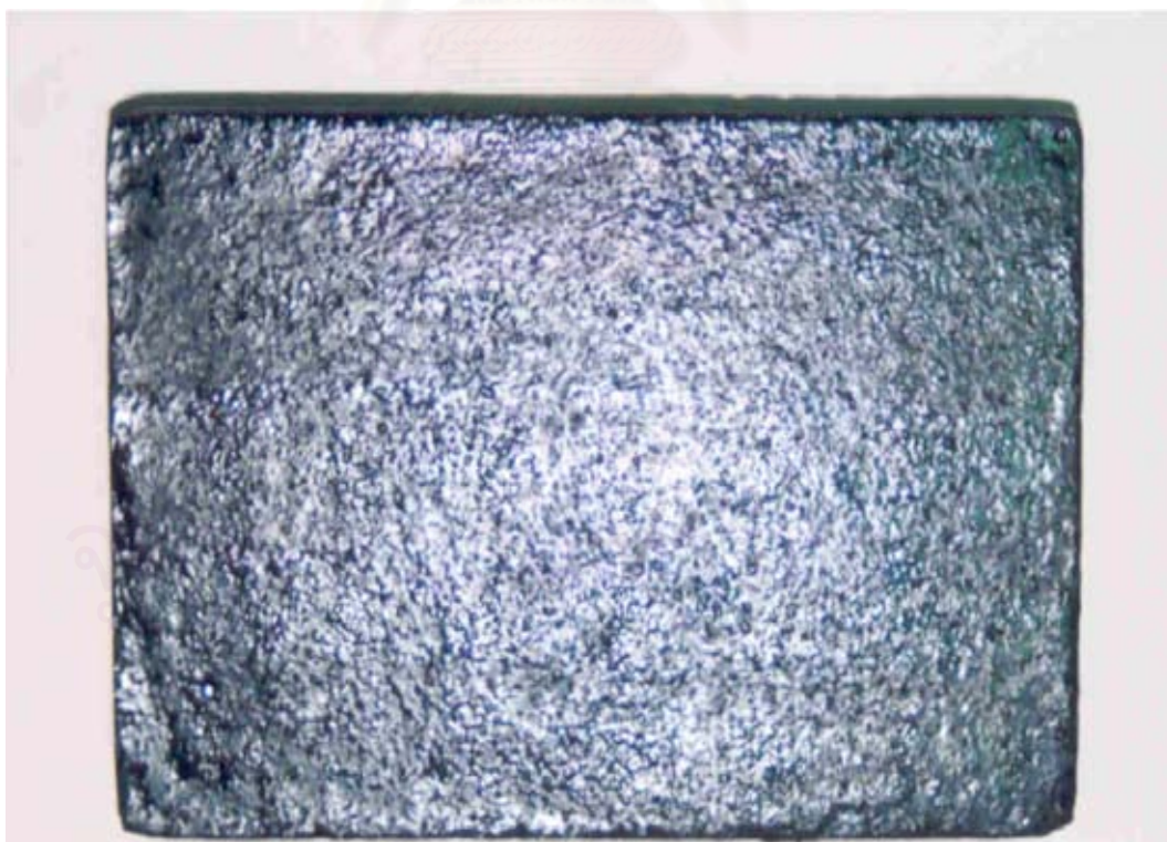
รูปที่ 3.10 แผ่นคอนกรีตทาสี epoxy
