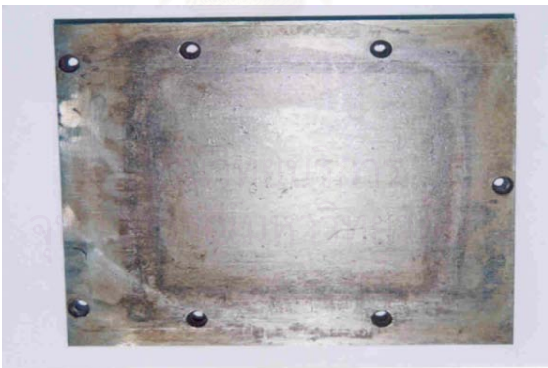
รูปที่ 3.4 แผ่นเหล็กผิวเรียบที่ใช้ในการทดสอบ
