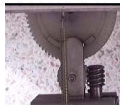
(ค) ระบบควบคุมการหมุนรอบแกนยก
