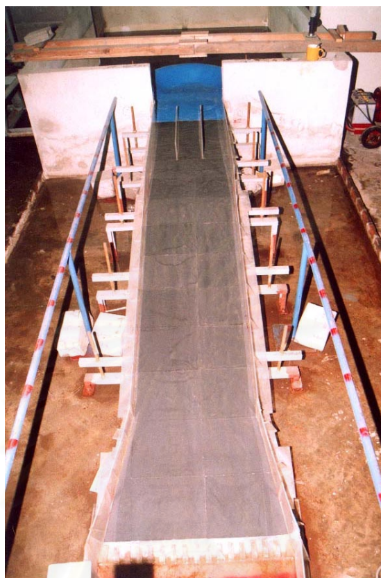
รูป ค-1 แบบจำลองรางเทของทางระบายน้ำล้นด้านบน
