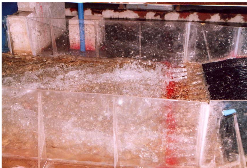
รูป ค-7 ทำน้ำของทางระบายน้ำล้นขณะทำการทดลอง
