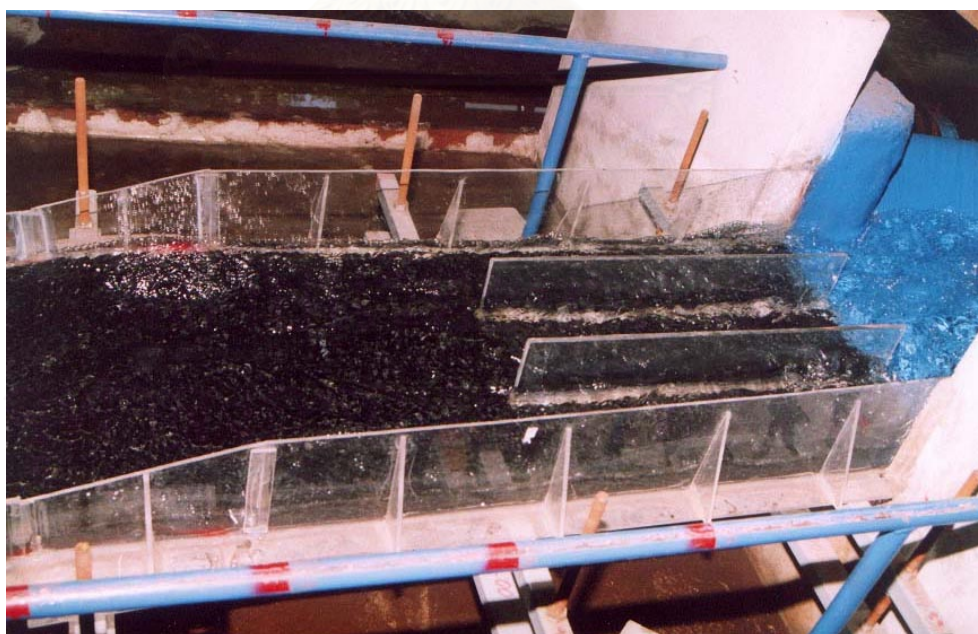
รูป ค-4 ทางน้ำเข้ารางเทของทางระบายน้ำล้นขณะทำการทดลอง
