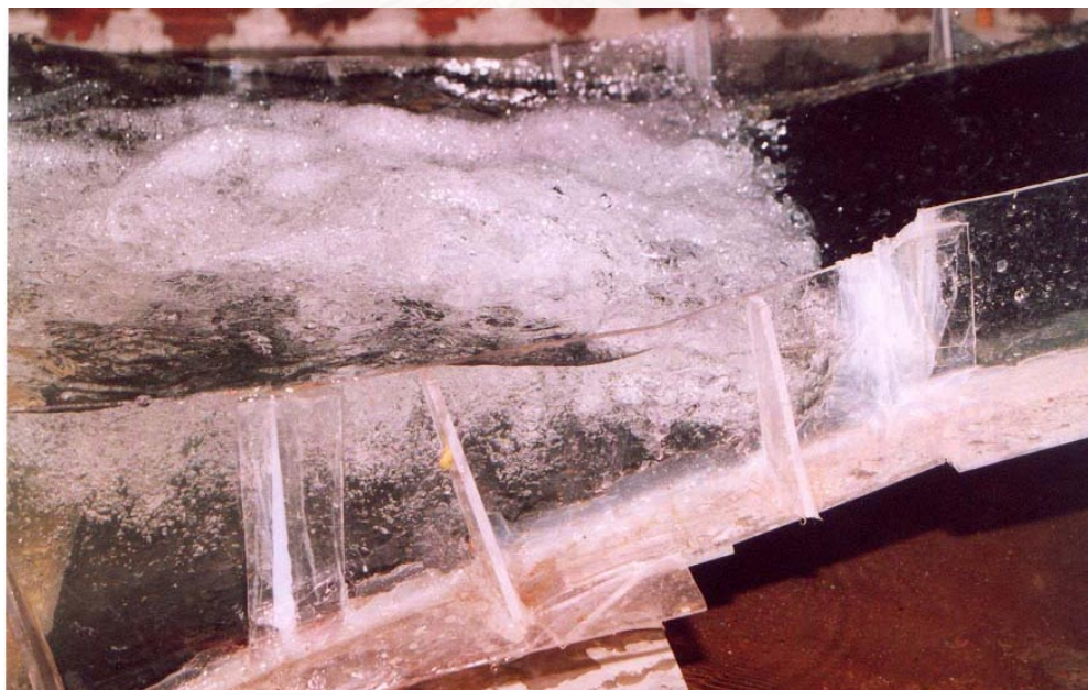
รูป ค-6 ทำยน้ำของทางระบายน้ำล้นขณะทำการทดลอง
