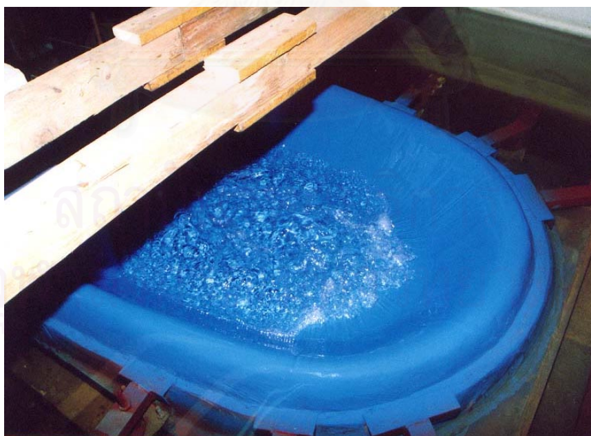
รูป ค-8 ฝ่ายสันโค้งของทางระบายน้ำด้นในแบบจำลองท่อสำหรับวัดอัตราการไหลในการทดลอง
