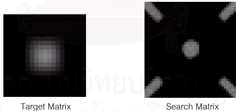
รูปที่ 3.6 แสดงจุดดัชนีที่เป็นภาพ Target matrix และ Search matrix ในการค่าพิกัด
