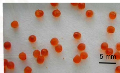
อัตราการไหลของวัสดุแกน 0.87 มิลลิลิตร/นาที่ และ อัตราการไหลของสารเคลือบ 14.51 มิลลิลิตร/นาที่
