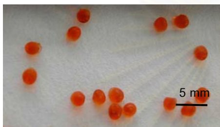
อัตราการไหลของวัสดุแกน 0.57 มิลลิลิตร/นาที่ และ อัตราการไหลของสารเคลือบ 10.03 มิลลิลิตร/นาที่
