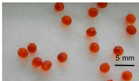
อัตราการไหลของวัสดุแกน 0.87 มิลลิลิตร/นาที่ และ อัตราการไหลของสารเคลือบ 14.51 มิลลิลิตร/นาที่
