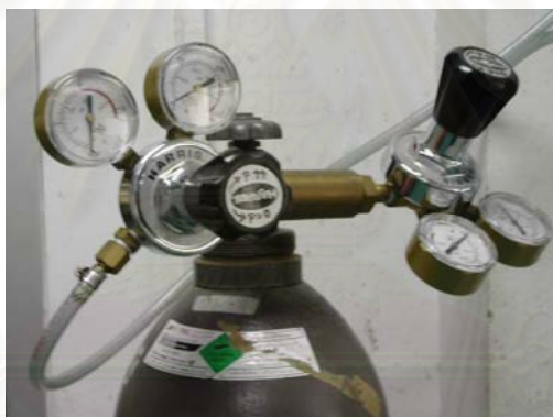
ภาพที่ 3.6 ถังก๊าซไนโตรเจนซึ่งต่อเข้ากับ regulator valve
