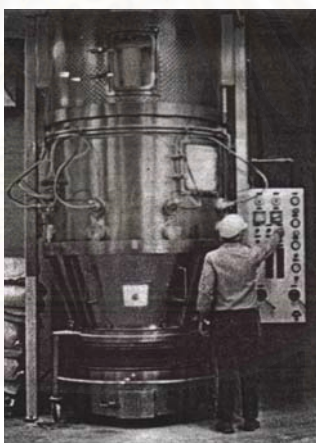
ภาพที่ 2.14 เครื่องมือที่ใช้ผลิตไมโครแคปซูลด้วยเทคนิคการเคลือบโดยการแขวนลอยในอากาศ ที่มา : Dziezak (1988)
