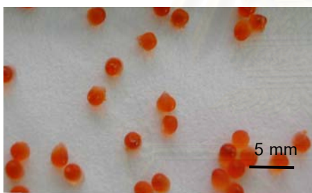
อัตราการไหลของวัสดุแกน 0.57 มิลลิลิตร/นาที่ และ อัตราการไหลของสารเคลือบ 14.51 มิลลิลิตร/นาที่
