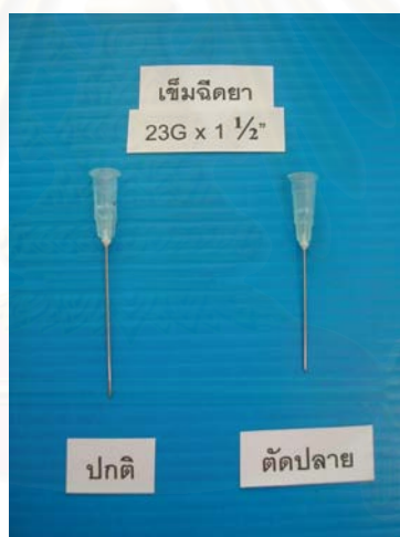
ภาพที่ 3.4 เข็มฉีดยาที่ใช้เป็นท่อด้านในของ bi-fluid nozzle
