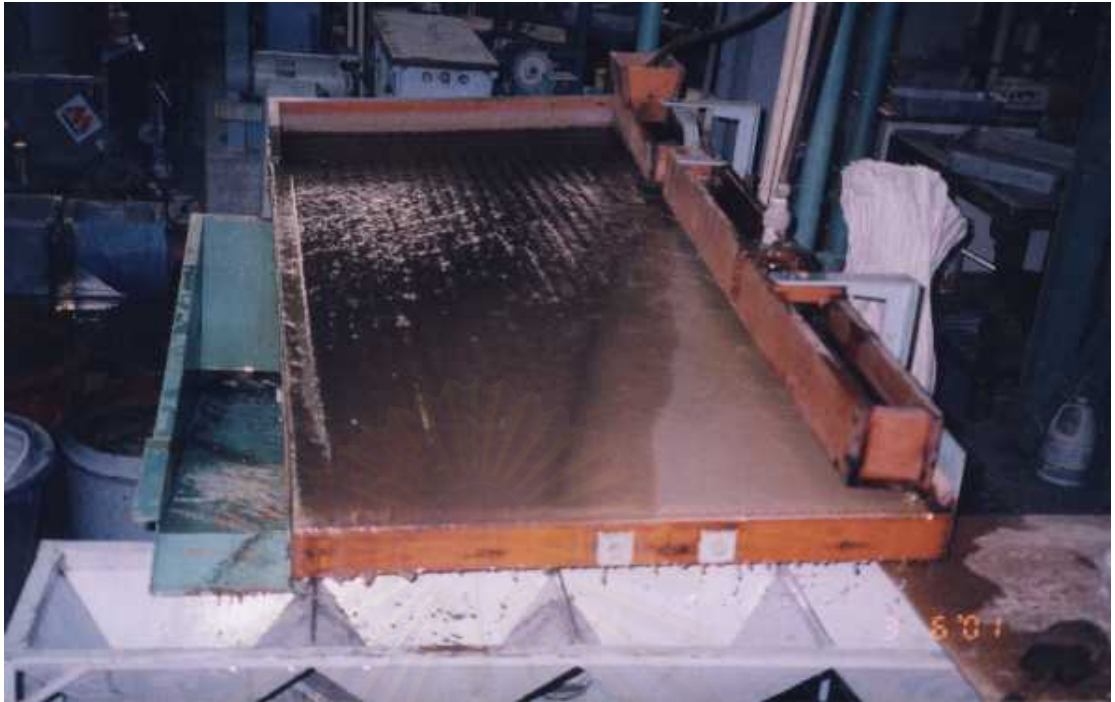
รูปที่ ข.10 การคัดแยกดินตะกอนด้วยโต๊ะเขย่าแบบเปียก
