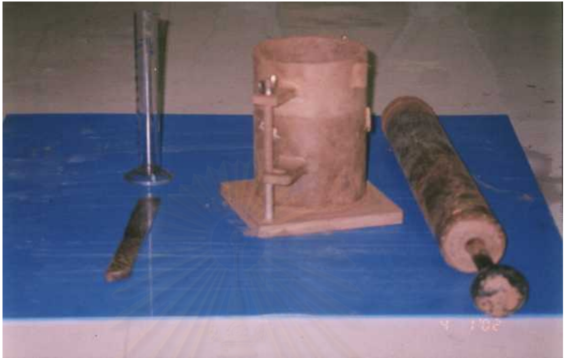
รูปที่ ข.7 อุปกรณ์สำหรับหาค่าปริมาณน้ำที่เหมาะสม (ASTM D698) และ การเตรียมสภาพดินตะกอน/กากตะกอน ก่อนวัดกำลังรับแรงอัด (ASTM D2166)
