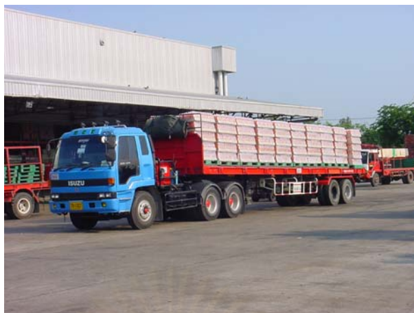
รูปที่ 3.5 รถบรรทุกขนาด 18 ล้อ ความจุขนาด 20 กระบะ
