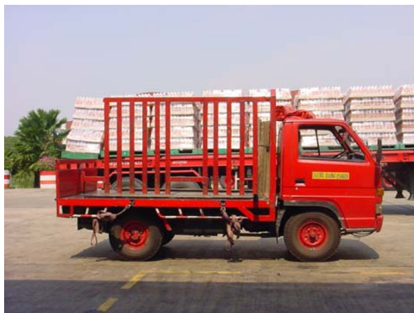
รูปที่ 3.2 รถบรรทุกขนาด 4 ล้อ ความจุขนาด 4 กระบะ
