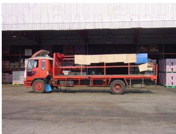
รูปที่ 3.4 รถบรรทุกขนาด 6 ล้อ ความจุขนาด 10 กระบะ
