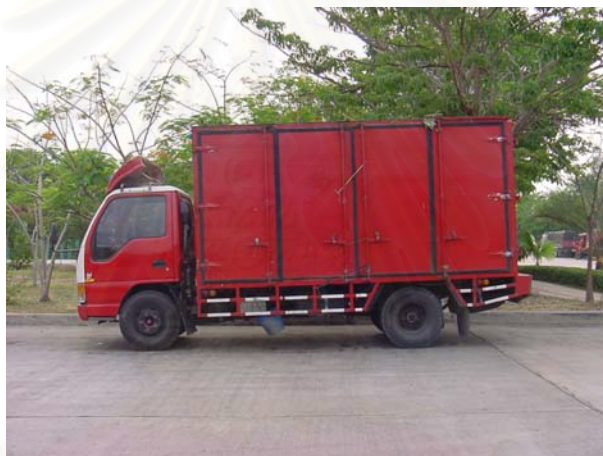
รูปที่ 3.3 รถบรรทุกขนาด 4 ล้อ ความจุขนาด 6 กระบะ
