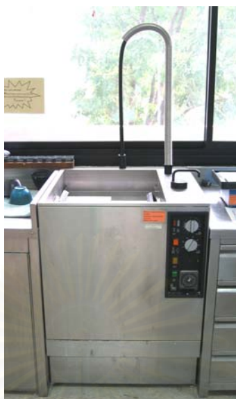
รูปที่ 13 แสดงภาพเครื่องกำจัดขี้ผึ้ง (Boil-out Unit, model EWL 5521, Kavo, West Germany)
