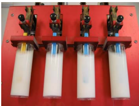
รูปที่ 35 แสดงภาพขณะแปร่งขึ้นตัวอย่างด้วยเครื่องแปร่งระบบดิจิทัล
