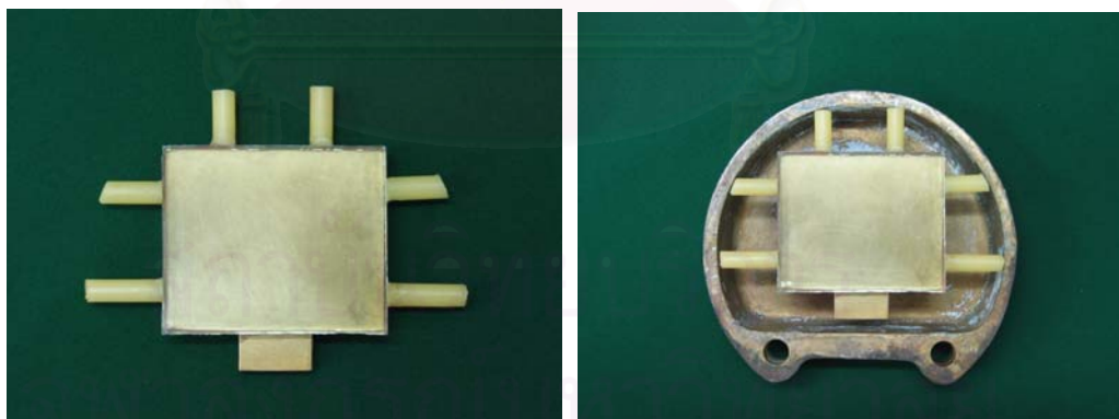
รูปที่ 8 แสดงภาพแม่แบบทองเหลืองยึดกับแผ่นกระจกใส และขี้ผึ้งสีงาช้าง
