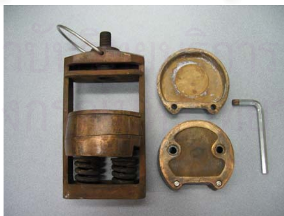
รูปที่ 9 แสดงส่วนประกอบของภาชนะหล่อแบบพื้นปลอมทองเหลือง
