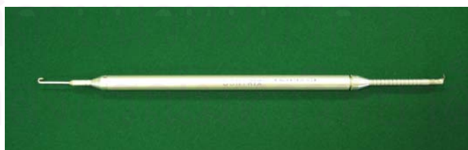
รูปที่ 37 แสดงภาพเครื่องวัดปริมาณความตึง (Dontrix tension gage, Dontrix ® , รุ่น 16 OZ, E.T.M. Corporation, 3M Unitek, Monrovia, California, U.S.A.)
