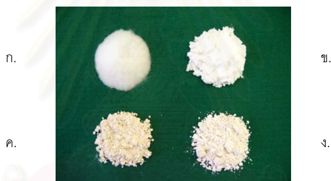
รูปที่ 15 แสดงภาพลักษณะ (ก) ผงโพลีเมทิลเมทาคริเลต, (ข) ผงแคลเซียมคาร์บอเนต, (ค) ผงดินขาว, (ง) ผงควอตซ์
