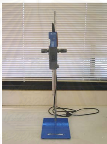
รูปที่ 36 แสดงภาพเครื่องกวนแบบแตกตัว (Dispersion Mixer, Ultra Turrax ® , รุ่น T25 basic, IKA Labortechnik, Malaysia)
