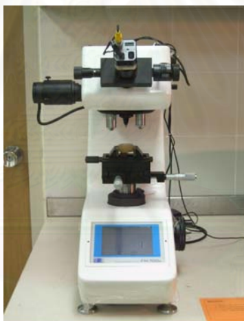
รูปที่ 28 แสดงภาพเครื่องวัดความแข็งผิวแบบจุลภาค (Microhardness Tester, รุ่น FM-700e, TYPE D, Future-tech CORP., Tokyo, Japan, Vicker indenter No. 33906 HV)
