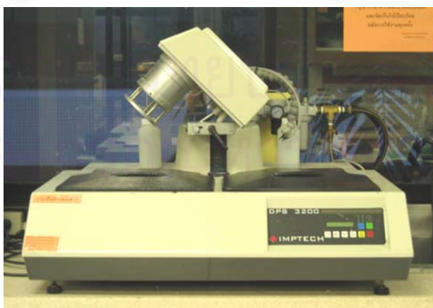
รูปที่ 25 แสดงภาพเครื่องขัดผิววัสดุระบบดิจิทัล (Digital Polishing Machine, รุ่น DPS 3200 Ser. 19965, Imptech, South Africa.)
