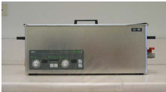
รูปที่ 27 แสดงภาพเครื่องทำความสะอาดด้วยคลื่นเหนือเสียง (Digital Ultrasonic Cleansing Unit, Transonic Digital S, รุ่น TP 20703100, Elma, Germany)
