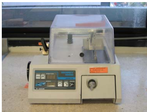
รูปที่ 20 แสดงภาพเครื่องตัดพื้น (Low speed cutting machine, รุ่น ISOMET 1000, BUEHLER, U.S.A.)
