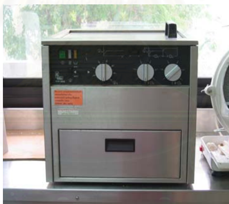
รูปที่ 17 แสดงภาพเครื่องบ่ม เรซิน อะคริลิก (Curing unit, model EWL 5518, Kavo, West Germany)
