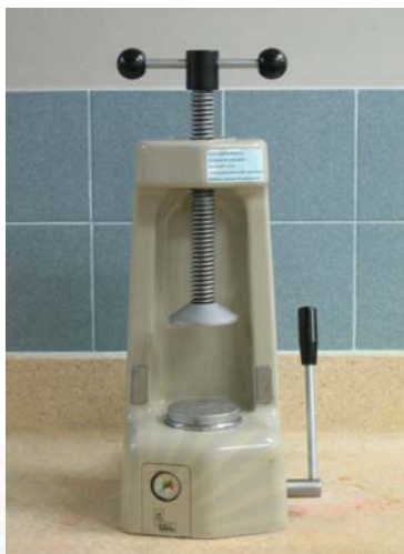
รูปที่ 12 แสดงภาพเครื่องอัดพลาสติกไฮดรอลิก (Hydraulic flask press, model EWL 5414, Kavo, West Germany)
