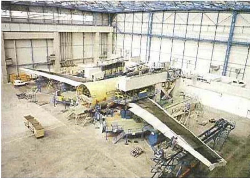
รูปที่ 2.12 รูปแบบการจัดสายการผลิตแบบงานอยู่กับที่ (Fixed-Position Layout)
