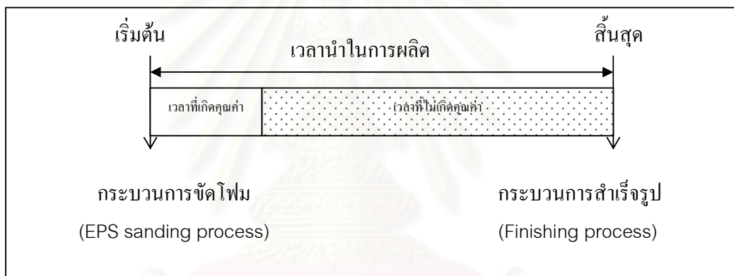
รูปที่ 3.12 ส่วนประกอบของเวลานำในการผลิต
