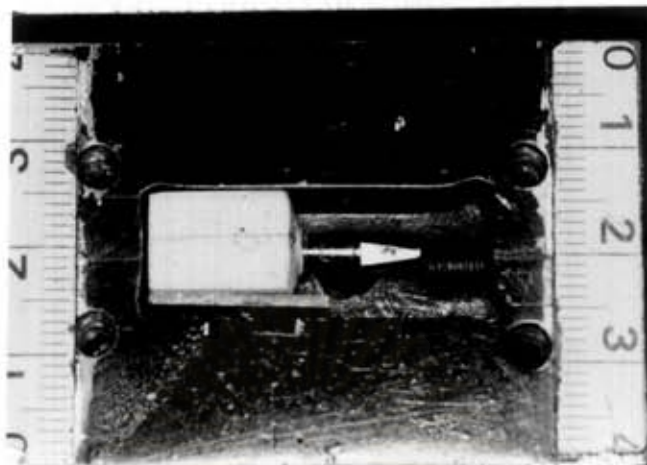
รูปที่19 แสดงแม่แบบทองเหลืองที่ใช้ยึดแท่งพลาสติกอร์หินในขณะที่ทำเครื่องหมายตรงรอยต่อของตัวหลัก กับตัวรากเทียม
