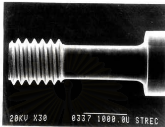
รูปที่ 2 แสดงรายละเอียดของตัวสกรูของตัวเหล็ก(ขยาย 30เท่า)
