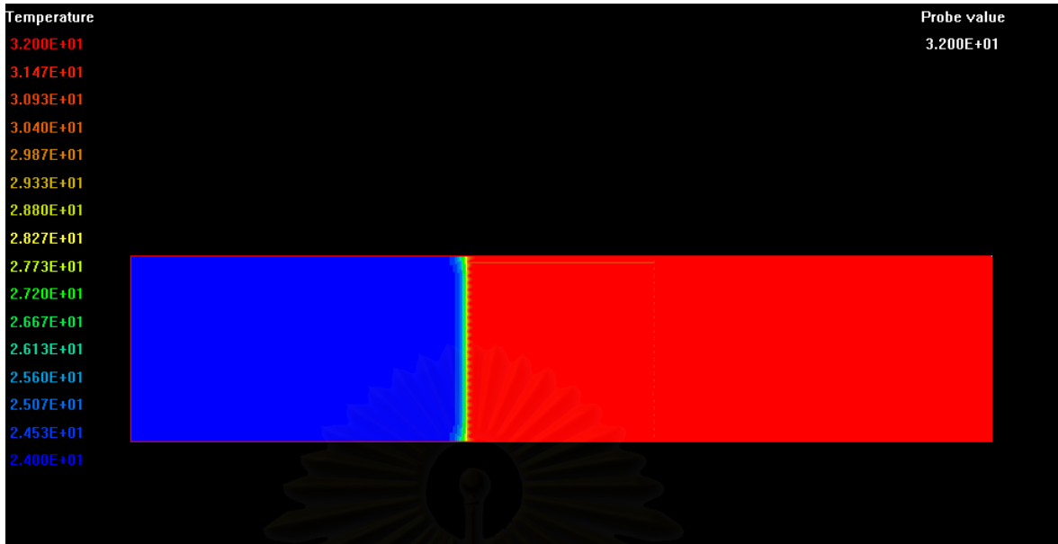
รูปภาพที่ 7.6 แสดงผลการกระจายตัวของอุณหภูมิกรณี Inline Continuous Plate Fin ที่ Re = 225
