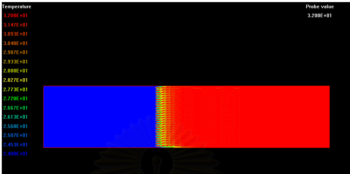
รูปภาพที่ 7.20 แสดงผลการกระจายตัวของอุณหภูมิกรณี Louver Plate Fin ที่ Re = 6239
