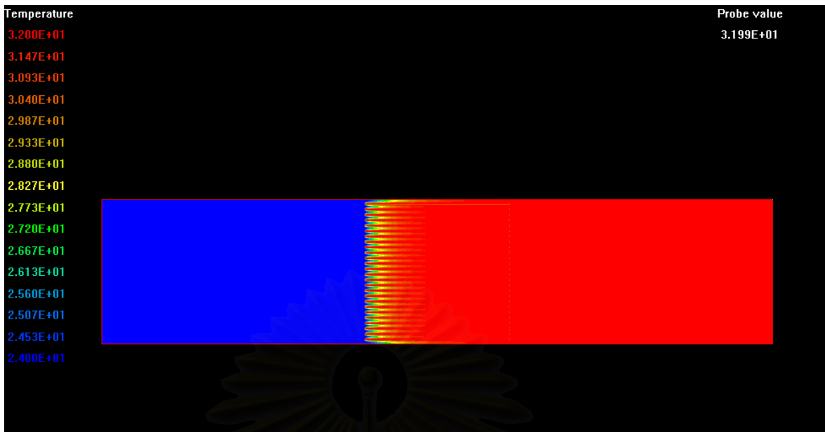
รูปภาพที่ 7.10 แสดงผลการกระจายตัวของอุณหภูมิกรณี Inline Continuous Plate Fin ที่ Re = 6239
