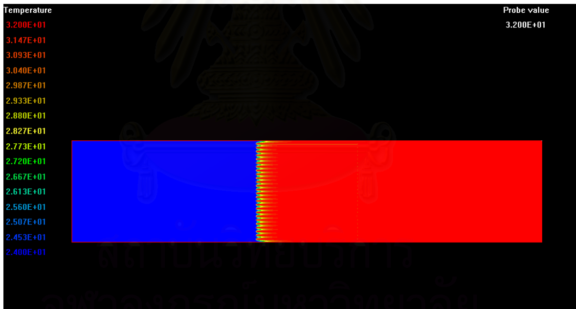
รูปภาพที่ 7.9 แสดงผลการกระจายตัวของอุณหภูมิกรณี Inline Continuous Plate Fin ที่ Re = 3157
