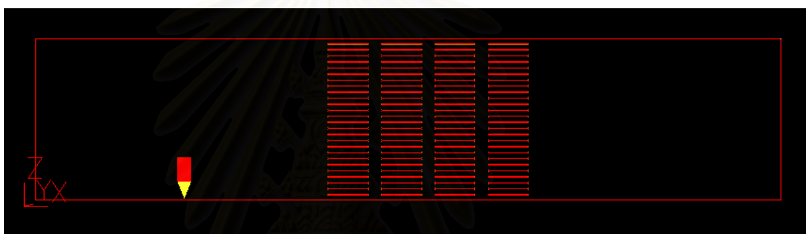
รูปภาพที่ 7.2 รูปภาพแสดงลักษณะของตัวครีบชนิด Inline Plate Fin
