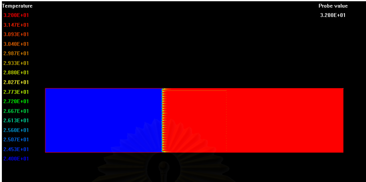
รูปภาพที่ 7.8 แสดงผลการกระจายตัวของอุณหภูมิกรณี Inline Continuous Plate Fin ที่ Re = 1343
