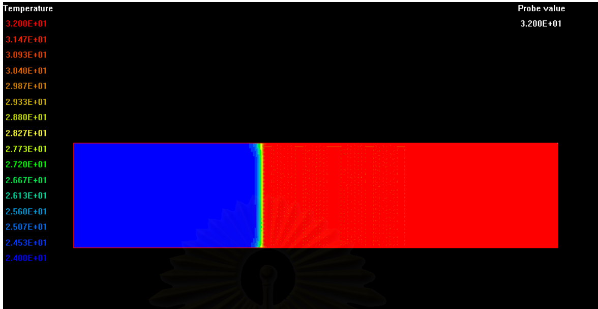
รูปภาพที่ 7.16 แสดงผลการกระจายตัวของอุณหภูมิกรณี Louver Plate Fin ที่ Re = 225
