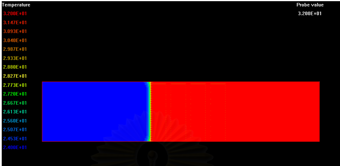
รูปภาพที่ 7.11 แสดงผลการกระจายตัวของอุณหภูมิกรณี Inline Plate Fin ที่ Re = 225
