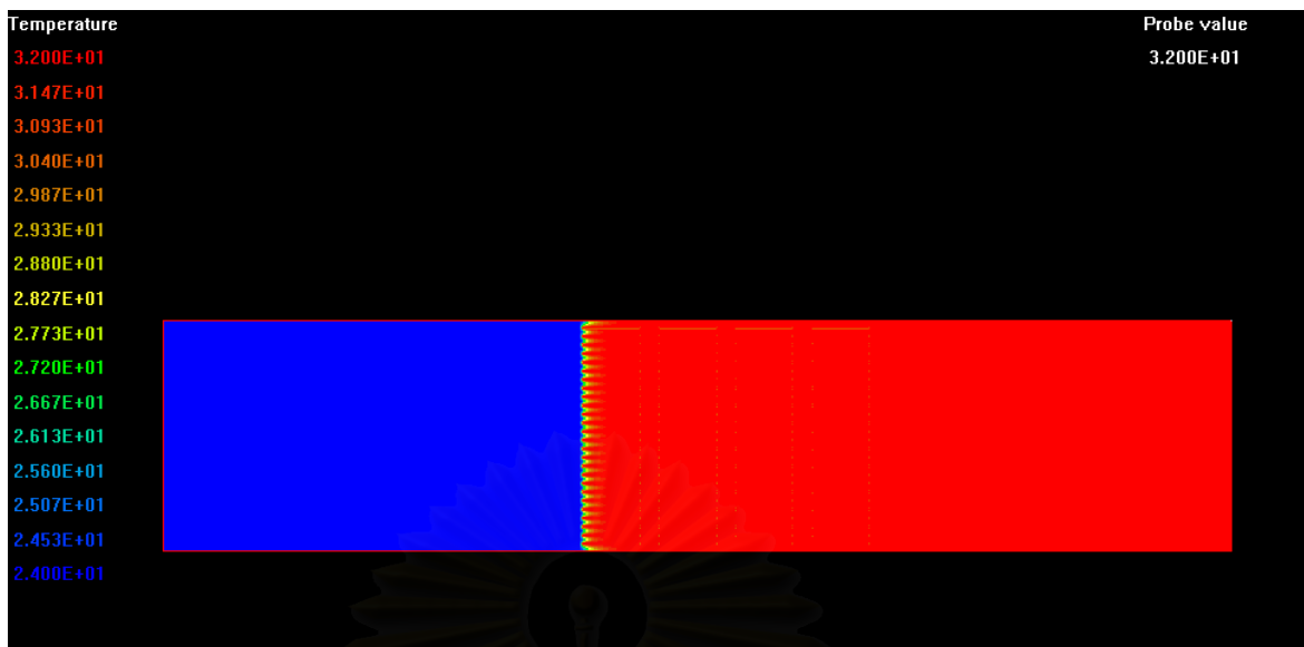
รูปภาพที่ 7.13 แสดงผลการกระจายตัวของอุณหภูมิกรณี Inline Plate Fin ที่ Re = 1343
