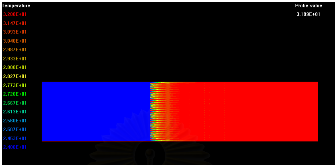
รูปภาพที่ 7.15 แสดงผลการกระจายตัวของอุณหภูมิกรณี Inline Plate Fin ที่ Re = 6239
