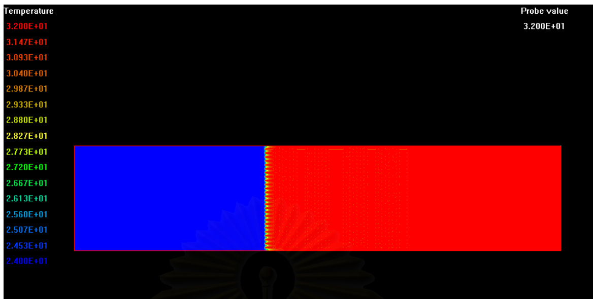
รูปภาพที่ 7.18 แสดงผลการกระจายตัวของอุณหภูมิกรณี Louver Plate Fin ที่ Re = 1343
