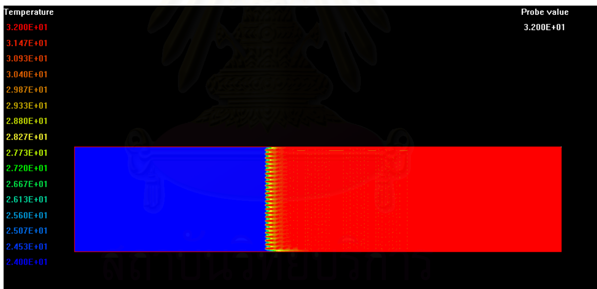
รูปภาพที่ 7.19 แสดงผลการกระจายตัวของอุณหภูมิกรณี Louver Plate Fin ที่ Re = 3157
