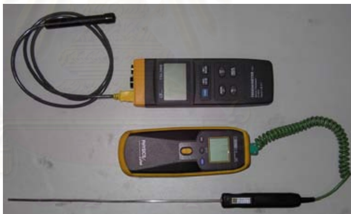
รูปที่ 3.10 เครื่องมือวัดอุณหภูมิแบบสัมผัส
