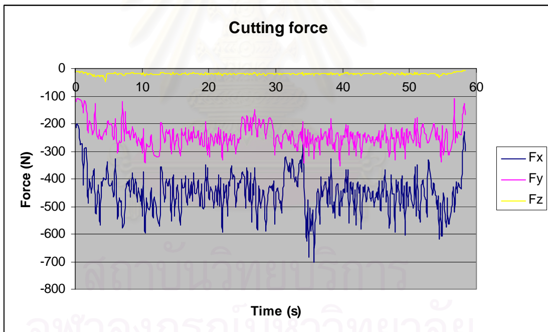
รูปที่ 8.13 แรงตัด F_x , F_y และ F_z ที่วัดได้จากการกัดในการทดลองที่ 7 โดยใช้อุปกรณ์ตรวจรู้แรงที่สร้างขึ้น
