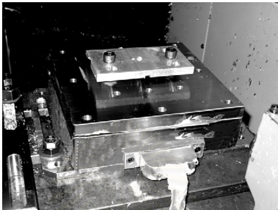
รูปที่ 3.18 การวางอุปกรณ์ตรวจรับแรงบนเครื่องกัดซีเอ็นซี
