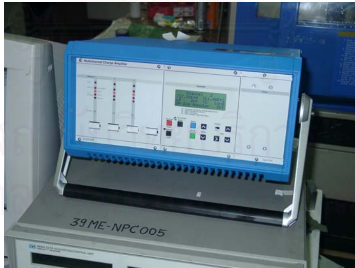
รูปที่ 2.27 ชาร์จแอมพลิฟายเออร์ รุ่น 2825A1-1
