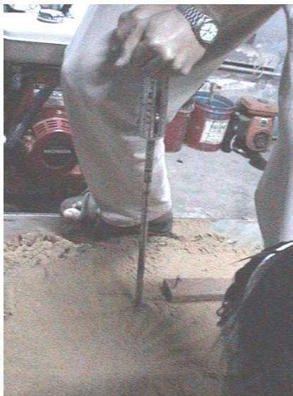
รูปที่ 6.16 การวัดความแน่นของทราย
