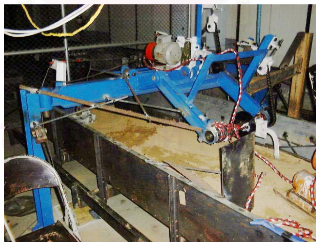
รูปที่ 5.4 ชุดทดลองเมื่อทำการเชื่อมยึดด้วยเหล็กข้ออ้อยเพื่อแก้ปัญหาการสั่นเนื่องจากแรงต้านทาน
