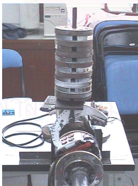
รูปที่ 6.14 การสอบเทียบกับไวมิดเมื่อ EOR ทำมุม 30 องศาที่ตำแหน่งระยะห่างจากศูนย์กลางตามความยาวของ EOR 3 เซนติเมตร
