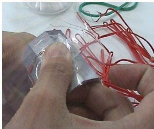
รูปที่ ค.15 การใช้ฉนวนกีดกันพลาสติก เพื่อป้องกันกาวติดมือ
