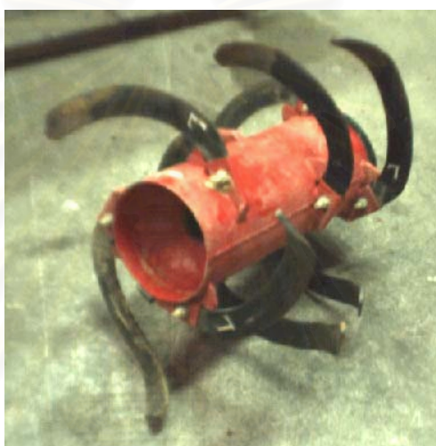
รูปที่ 5.11 การจัดเรียงไบมีดบนกระบะบอกพรวนของรถไถพรวนดิน Honda FA500 ด้านซ้าย
