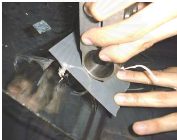
รูปที่ ค.8 วิธีการขัด EOR ด้วยกระดาษทรายน้ำบนกระจก
