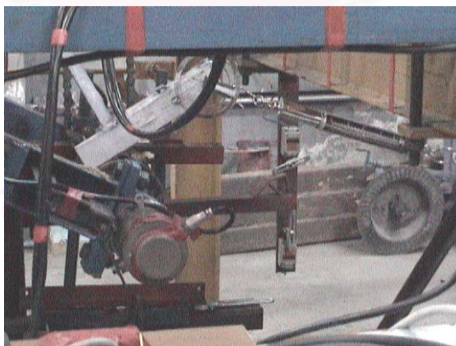
รูปที่ 5.29 ใช้ชุดทดลองทำการสอบเทียบกับแรงที่มากกระทำกับ EOR ในทิศทางต่างๆ
