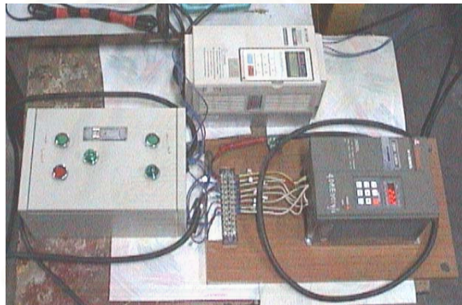
รูปที่ 5.25 ระบบควบคุมความเร็วที่ใช้อินเวอร์เตอร์
