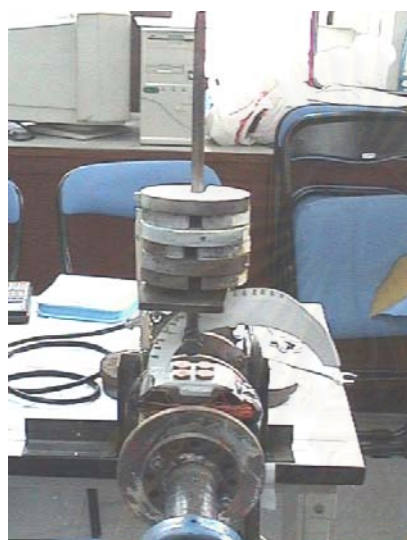
รูปที่ 6.11 การสอบเทียบใบมีดกับแรงกด F ตรงตำแหน่งแนวศูนย์กลางตามความยาวของ EOR
