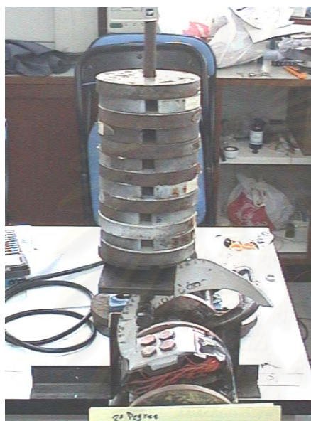
รูปที่ 6.13 การสอบเทียบกับไวมิดเมื่อ EOR ทำมุม 20 องศาที่ตำแหน่งระยะห่างจากศูนย์กลางตามความยาวของ EOR 2 เซนติเมตร
