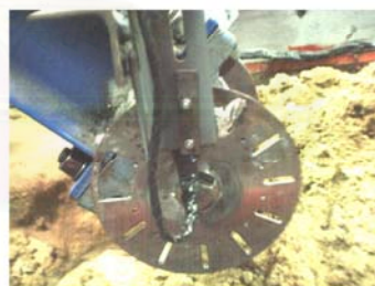
รูปที่ 5.13 ล้อและสวิตซ์แสงที่ใช้เป็นตัวตรวจวัดมุม
