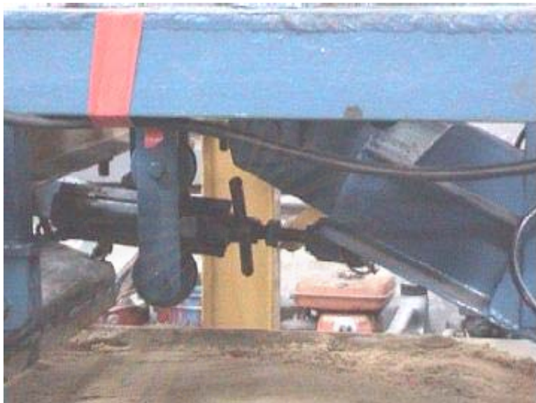
รูปที่ 5.21 สลักเกลียวสำหรับตั้งความลึกในการพรวน
