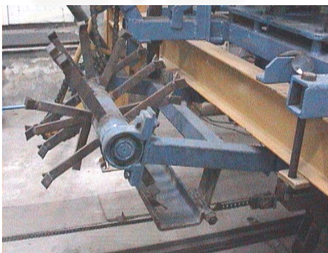
รูปที่ 5.28 ชุดพรวนทรายสำหรับการเตรียมทรายในการทดลอง
