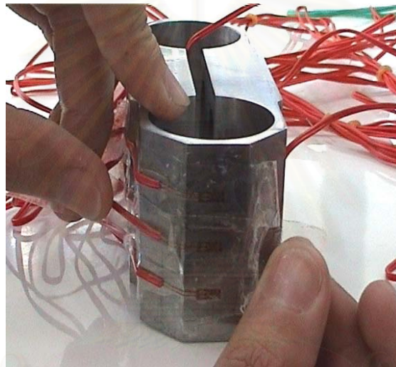
รูปที่ ค.13 การติดสเตรนเกจด้วยเทปกาวแบบใสบน EOR
