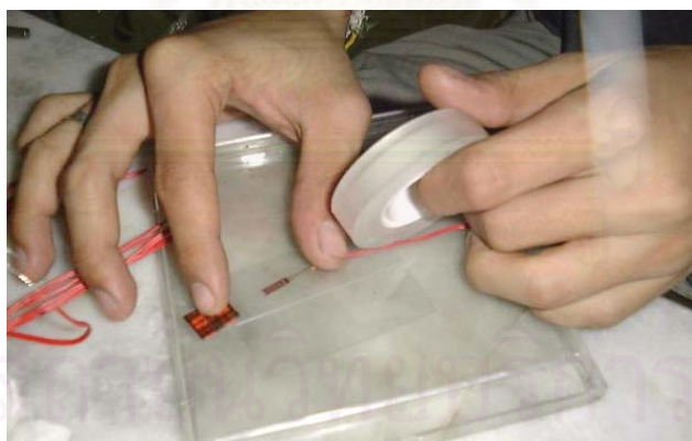
รูปที่ ค.11 การติดเทปกาวแบบใสบนสเตรนเกจ
