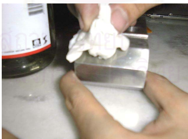
รูปที่ ค.9 เช็ด EOR ด้วยน้ำยา Acetone
