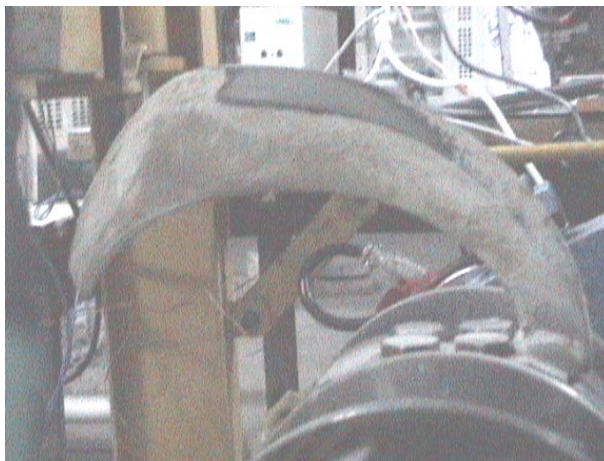
รูปที่ 7.32 ด้านหลังของไวมัดหลังการพรวน ในการทดลองไวมัดใบเดี่ยวที่ความเร็ว 75 รอบต่อนาที ระยะเวลาตัดทอย 9 เซนติเมตร
