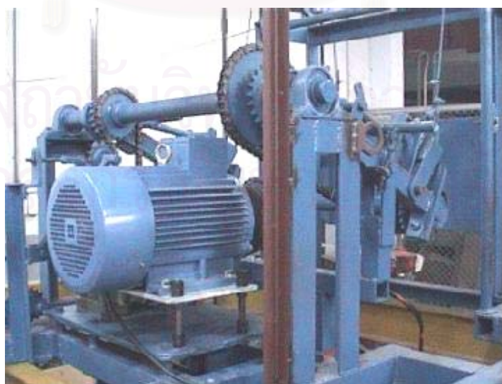
รูปที่ 5.20 ชุดมอเตอร์ที่ใช้ในการขับเพลลาไม่มีด
