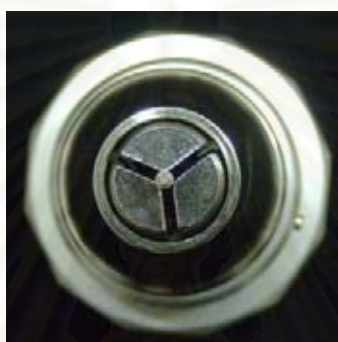
รูปที่ 29 แสดงส่วนก้ามจับของเครื่องวัดแรงบิดจับยึดด้ามไขควง
