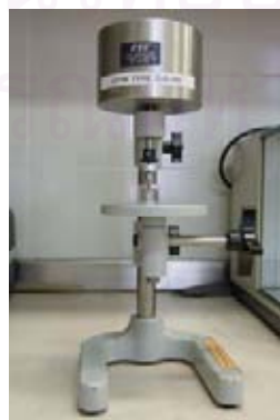
รูปที่ 32 แสดงเครื่องดูโรมิเตอร์ขณะกดส่วนรับแรงครึ่งทรงกลม
