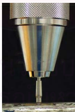
รูปที่ 30 แสดงการขึ้นสกรูหลักยึดด้วยไขควงที่ด้ามต่อเข้ากับเครื่องวัดแรงบิด
