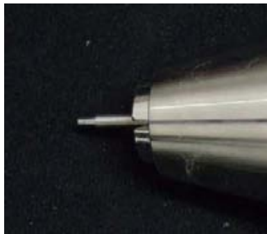
รูปที่ 28 ภาพขยายการนำเครื่องวัดแรงบิดต่อเข้ากับด้ามไขควง
