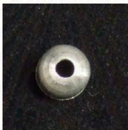
รูปที่ 18 แสดงด้านบนของส่วนรับแรงครึ่งทรงกลมที่มีรูตรงกลางเพื่อใช้ในการคลายเกลียวสกรูหลังผ่านการทดสอบความล้า
