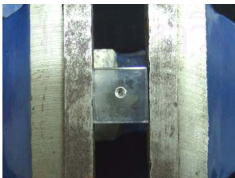
รูปที่ 24 แสดงการยึดกล่องพลาสติกด้วยเครื่องยึดตลับรองป้องกันการหมุนขณะขันสกรู
