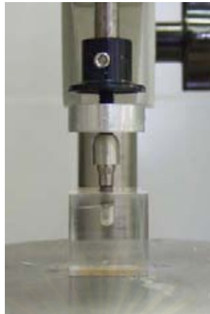
รูปที่ 33 ภาพขยายเครื่องดูโรมิเตอร์ขณะกวดส่วนรับแรงครึ่งทรงกลม
