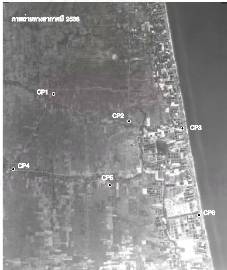
รูป 4-1 การกำหนดจุดบ่งคับภาคพื้นดิน (CP)
