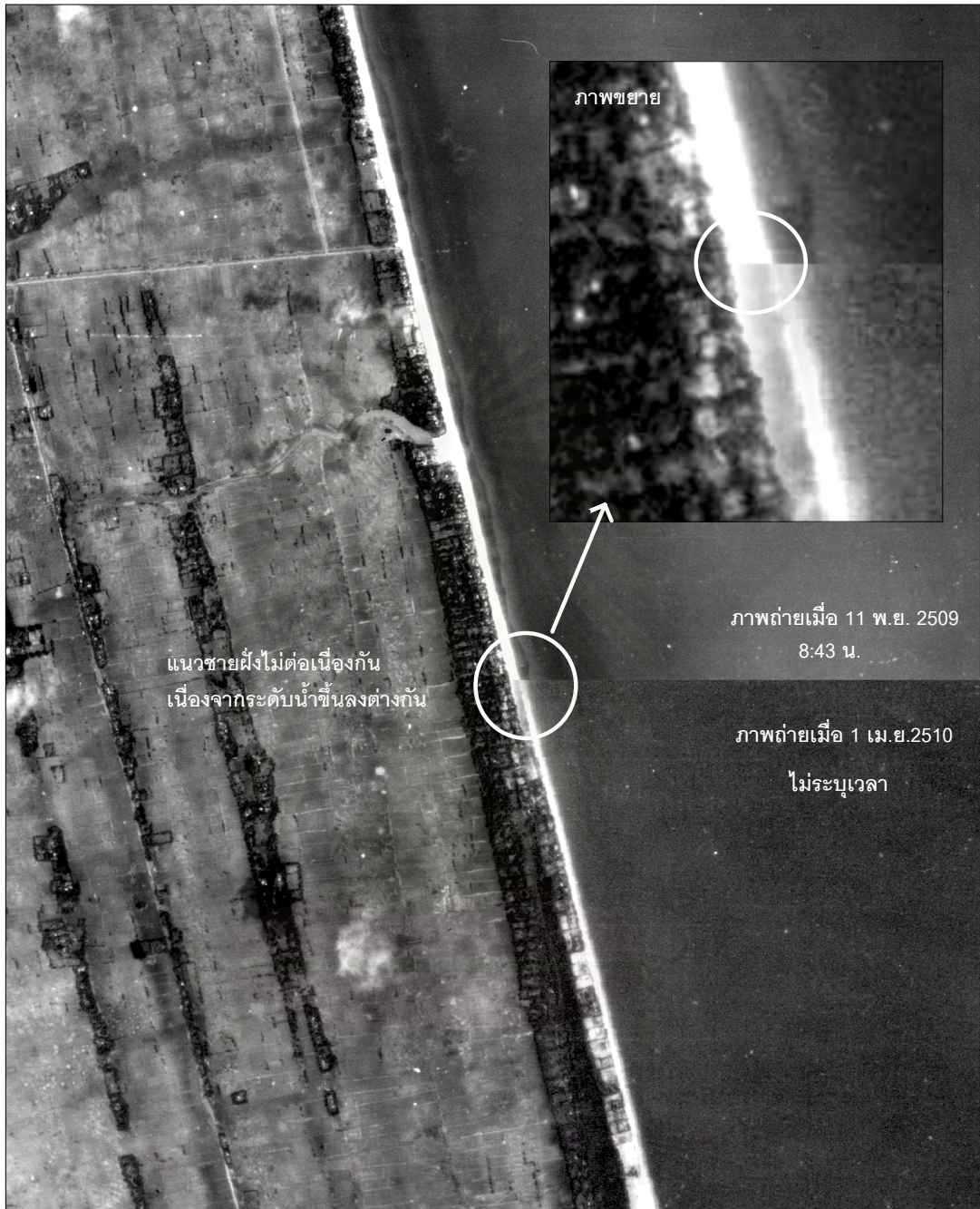
รูป 4-4 ตัวอย่างภาพถ่ายที่ได้รับอิทธิพลจากน้ำขึ้น-ลงไม่เท่ากัน
