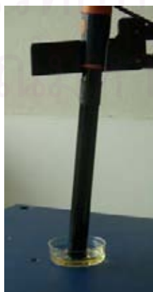
ภาพที่ 18 การวัดปริมาณฟลูออไรด์ในสารละลายตัวอย่าง
