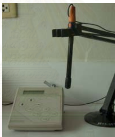
ภาพที่ 16 ฟลูออไรด์อิเล็กโทรดที่ต่อกับเครื่องวิเคราะห์หีออนในสารละลาย
