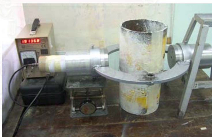
รูปที่ 3.4 ภาพการจัดระบบวัดท่อเหล็กกล้าที่ใช้งานจริง โดยใช้อุปกรณ์จับเคลื่อนหัววัดรังสี และต้นกำเนิดรังสีที่พัฒนาขึ้น (ไม่มีคอลลิเมเตอร์หน้าหัววัดรังสี)
