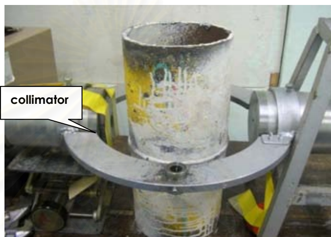
รูปที่ 3.3 ภาพการจัดระบบวัดท่อเหล็กกล้าที่ใช้งานจริง โดยใช้อุปกรณ์จับเคลื่อนหัววัดรังสี และต้นกำเนิดรังสีที่พัฒนาขึ้น (มีคอลลิเมเตอร์หน้าหัววัดรังสี)
