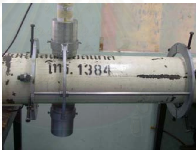
รูปที่ 4.6 ภาพการตรวจวัดความหนาของท่อเหล็ก (ถึงก๊าซอาร์กอน)
