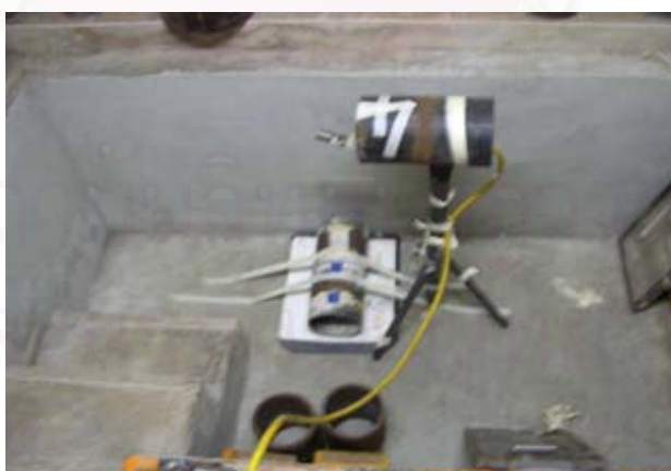
รูปที่ 3.6 ภาพแสดงการตรวจสอบด้วยเทคนิคถ่ายภาพด้วยรังสีแกมมาต่อเหล็กกล้า
