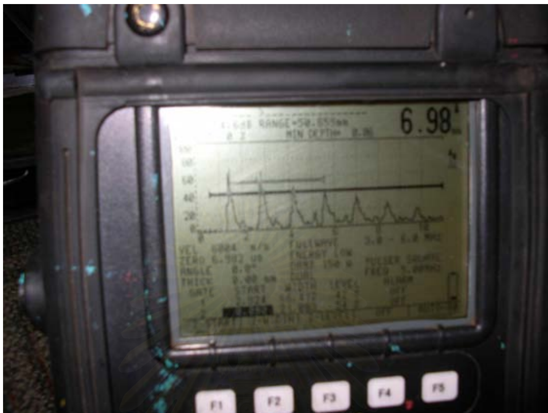
รูปที่ 4.11 ภาพผลการทดสอบท่อเหล็กกล้าด้วยวิธีอัลตราโซนิก
