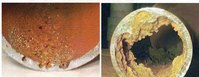
รูปที่ 1.1 ภาพที่เกิดความเสียหายภายในท่อ
