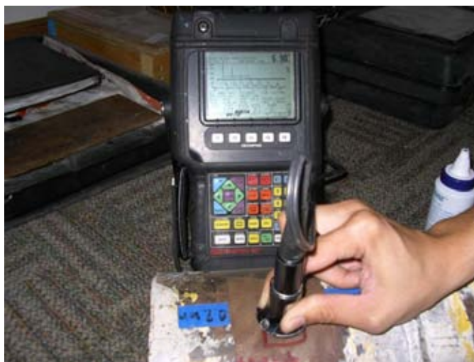
รูปที่ 3.7 ภาพแสดงการตรวจสอบท่อเหล็กกล้าด้วยวิธีอัลตราโซนิก
