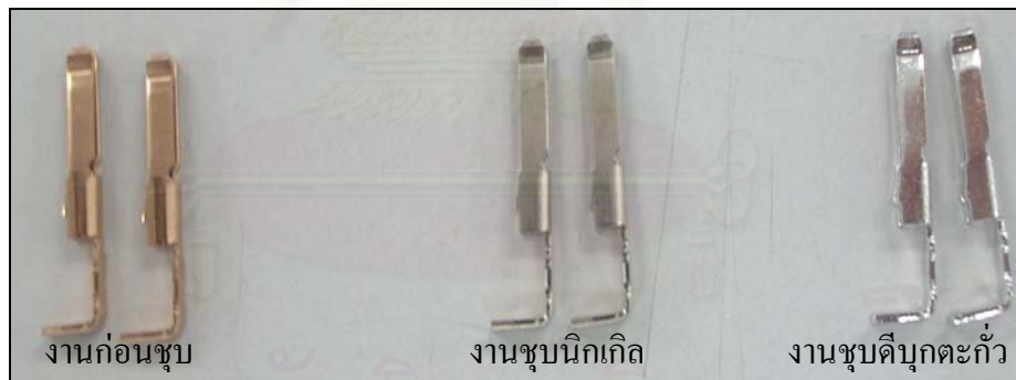
รูปที่ 3.10 ลักษณะของงานชุบนิกเกิลและตีบุกตะกั่ว
