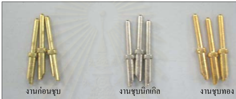
รูปที่ 3.9 ลักษณะของงานชุบนิกเกิลและทอง
