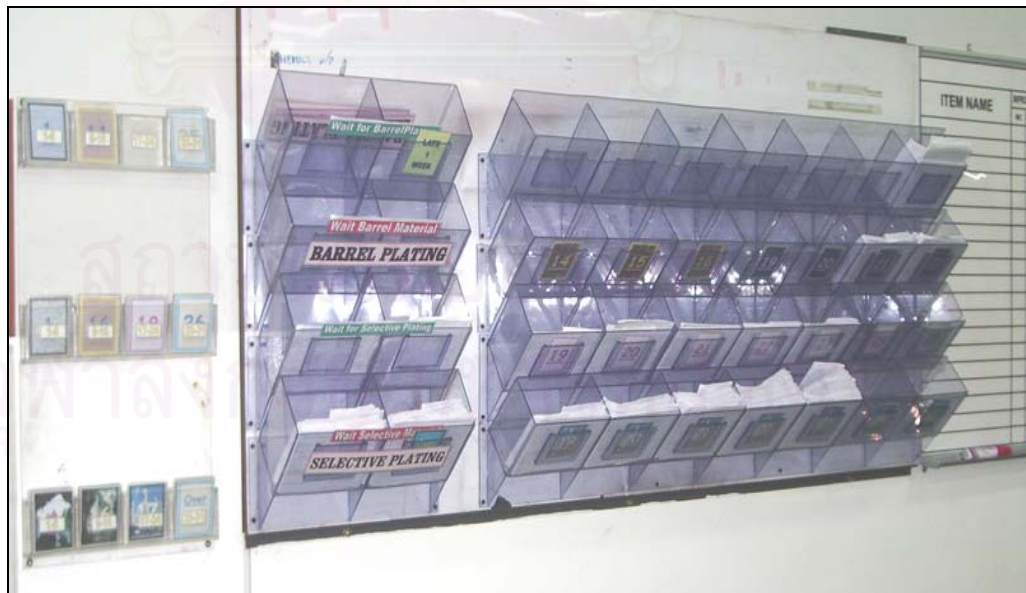
รูปที่ 3.22 การจัดเรียงใบกำกับผลิตภัณฑ์ตามวันที่ให้ทำการผลิต 1 ช่อง/วัน
