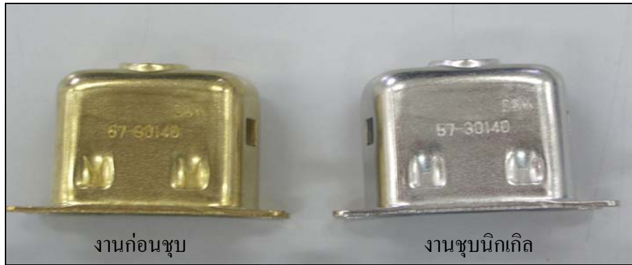
รูปที่ 3.8 ลักษณะของงานชุบนิกเกิลอย่างเดียว
