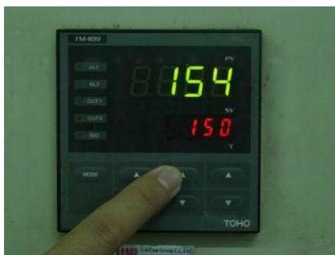
รูปที่ 10. กดลูกศรขึ้นในหลักสิบตัวเลขจะเพิ่มขึ้นทีละ 10
