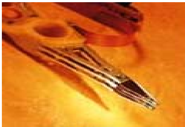
รูปที่ 2.4 ชุดของหัวอ่านเขียนที่ติดตั้งบนแขนจับซึ่งพร้อมจะประกอบในฮาร์ดดิสก์ หรือที่เรียกว่า Head Stack Assembly, HSA
