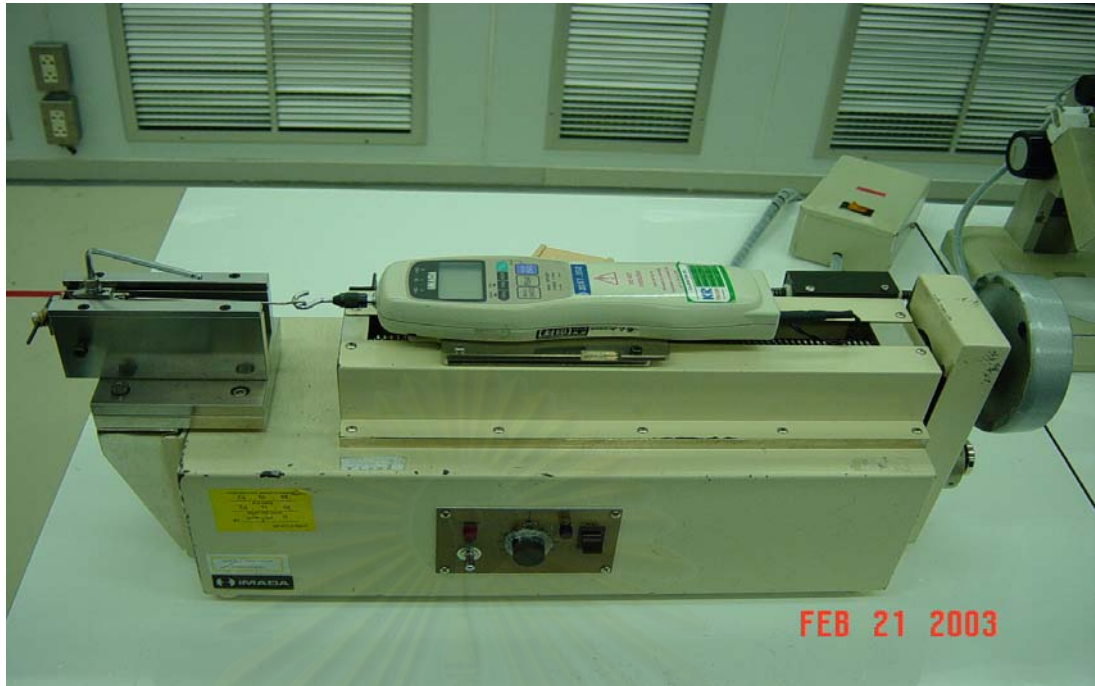
รูปที่ 3.5 : เครื่องทดสอบความแข็งแรงของรอยเชื่อม
