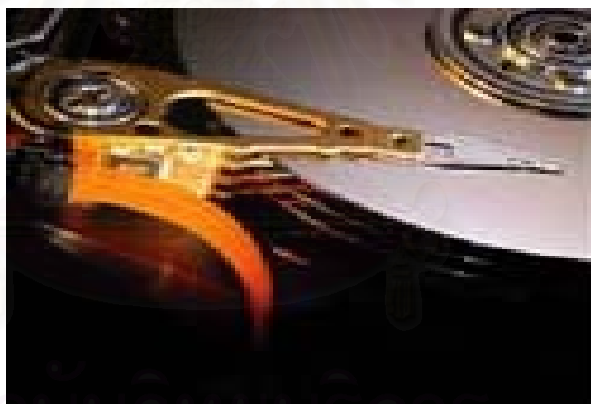
รูปที่ 2.5 HSA ที่ประกอบลงใน HDD
