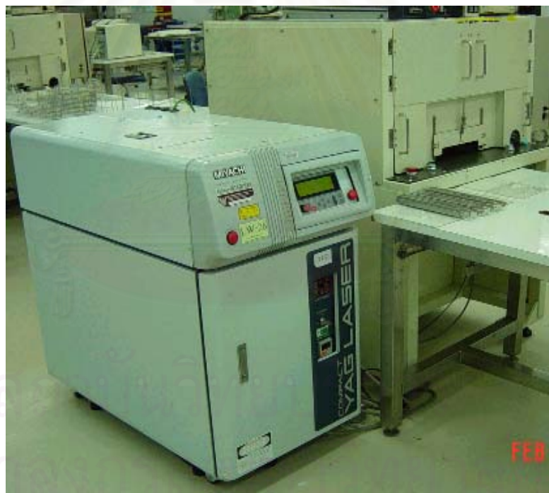
รูปที่ 3.2 : เครื่องเชื่อมแก๊กละเซอร์แบบจุด (Nd:YAG Spot Welding)
