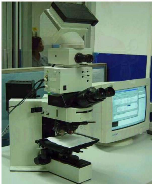
รูปที่ 3.6 : กล้องถ่ายภาพกำลังขยายสูง 2500 เท่า ซึ่งใช้สำหรับถ่ายภาพความลึกของรอยเชื่อมที่ตัดขวางแล้วหล่ออยู่ในเรซิน
