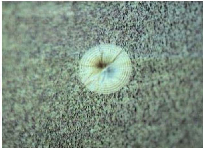
รูปที่ 4.4 รอยเชื่อมด้านหลังที่กำลังขยาย 500 เท่า
