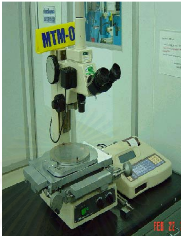
รูปที่ 3.7 : เครื่องมือวัด MTM สำหรับใช้วัดขนาดของรอยเชื่อม
