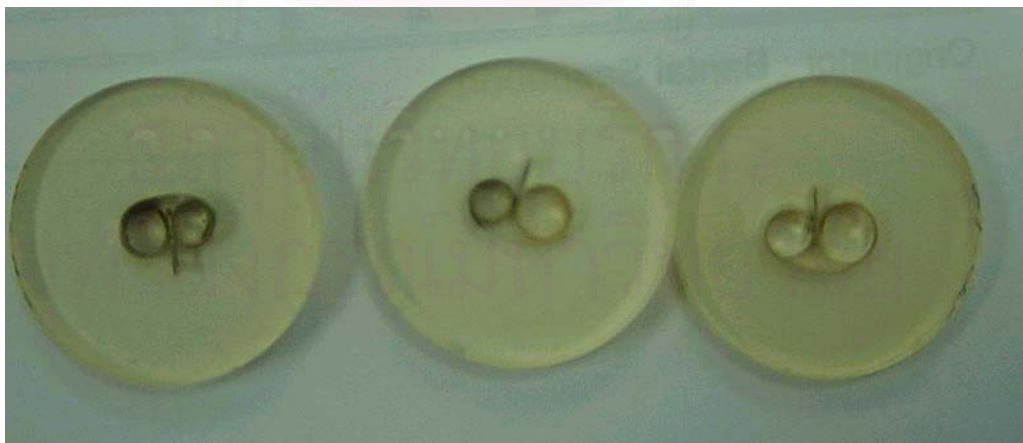
รูปที่ 3.8 : ภาคตัดขวางของรอยเชื่อมซึ่งหล่ออยู่ในเรซิน
