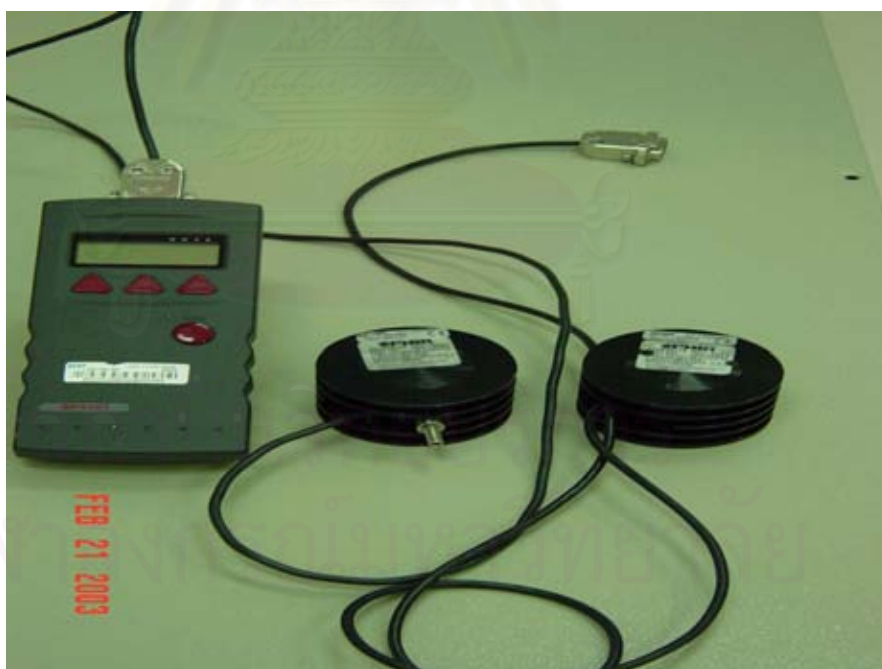
รูปที่ 3.4 : เครื่องมือวัดพลังงาน (Calorie Meter)
