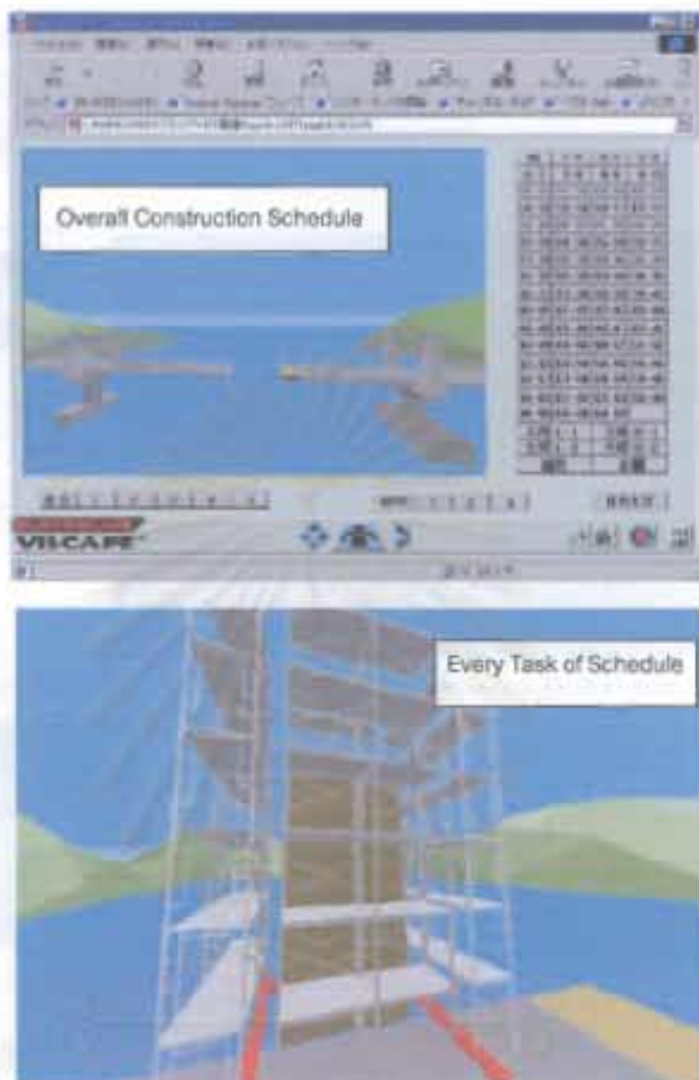
รูปที่ 2.4 แสดงการนำแบบจำลองเสมือนจริงแสดงภาพสามมิติของโครงการและภาพ 3 มิติในช่วงเวลาการทำงานก่อสร้างในชั้นตอนที่มีความไม่ชัดเจนหรือการคาดการณ์ที่คลุมเครือ (Ogata, et al. 2000)
