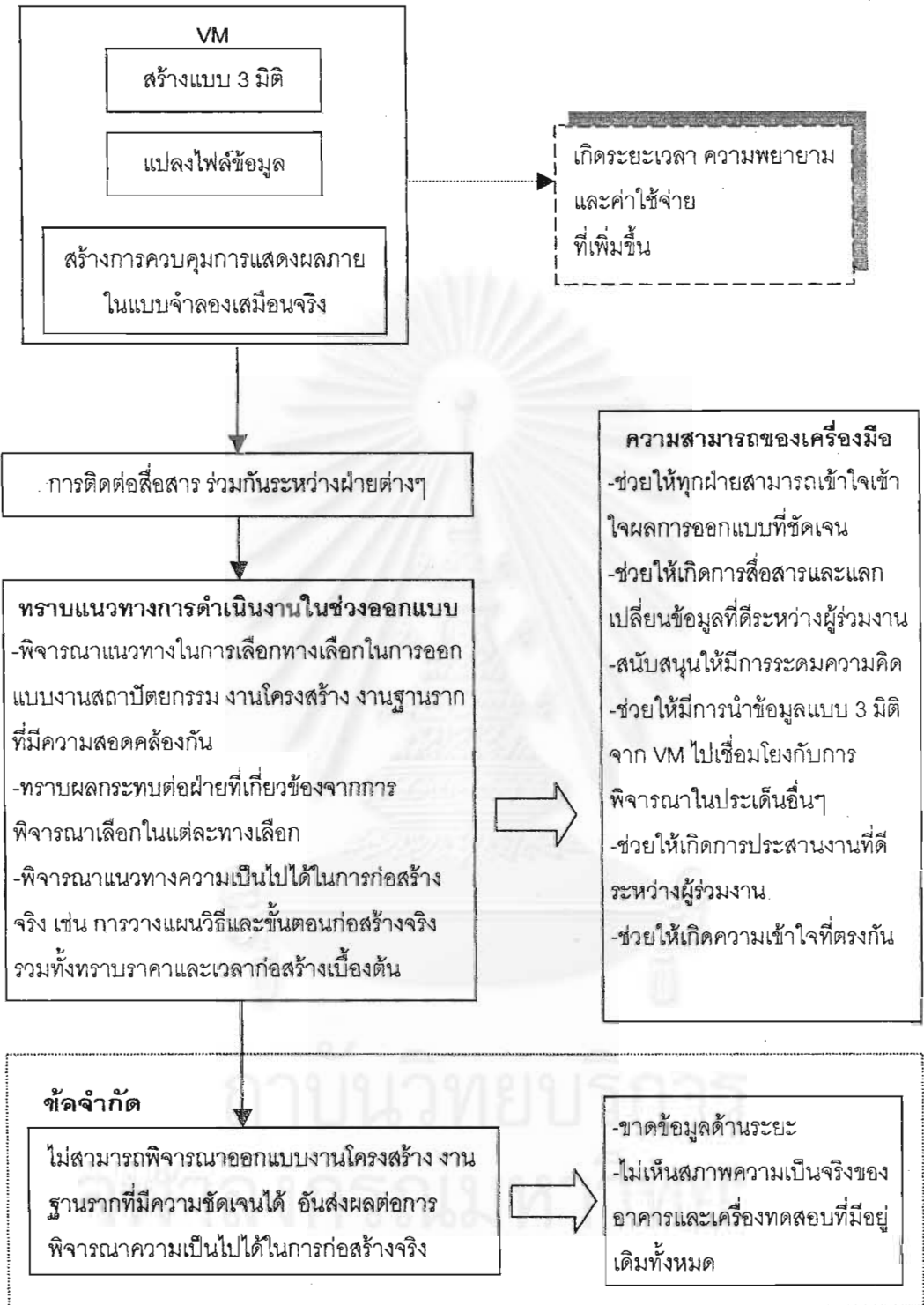
รูปที่ 5.2 แสดงการนำแบบจำลองเสมือนจริงมาใช้ในการติดต่อประสานงานในช่วงออกแบบ
