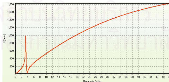
รูปที่ 7.13 อิมพีแดนซ์สมมูลที่บัส 2 เมื่อโหลดมีขนาด 2000 kVA, ดีจูน 13 ชุด
