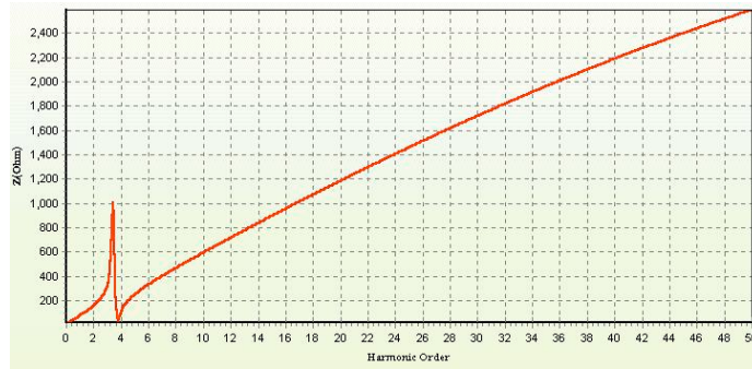
รูปที่ 7.10 อิมพีแดนซ์สมมูลที่บัส 2 เมื่อโหลดมีขนาด 1000 kVA, ดีจูน 9 ชุด
