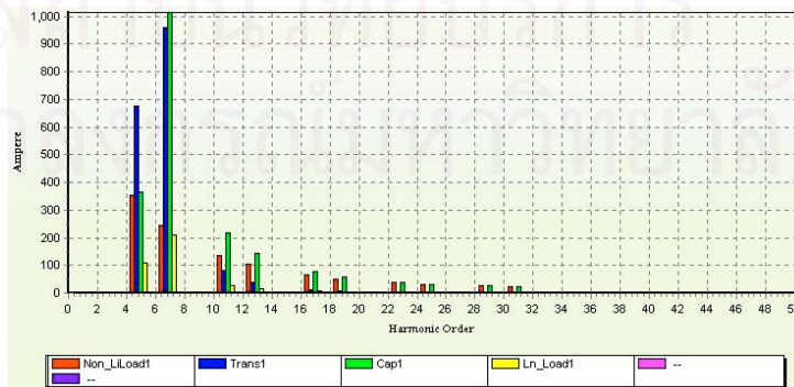
รูปที่ 7.9 ขนาดของกระแสในอุปกรณ์ เมื่อโหลดมีขนาด 2000 kVA, คาปาซิเตอร์ 14 ชุด
