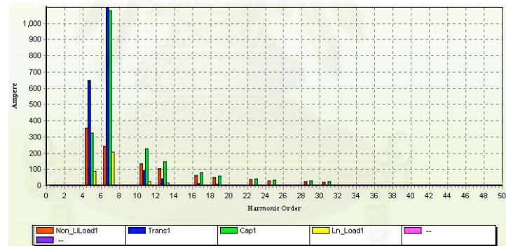
รูปที่ 7.8 ขนาดของกระแสในอุปกรณ์ เมื่อโหลดมีขนาด 1700 kVA, คาปาซิเตอร์ 13 ชุด
