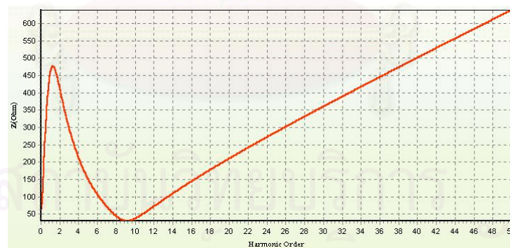
รูปที่ 7.27 อิมพีแดนซ์สมมูลเพื่อวิเคราะห์การเกิด series resonance เมื่อโหลดมีขนาด 1250 kVA, ในตัวอย่างที่ 3
