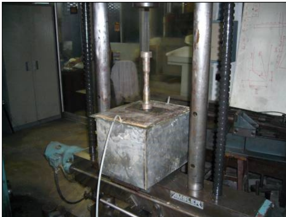
รูป 3.6 ปัดกระเบเหล็กโดยให้มีรูสำหรับสายยางลอดออกมาได้ 2 รู
