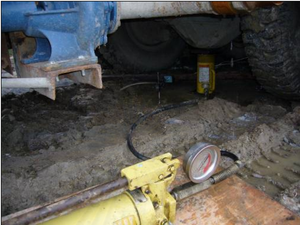
รูป ผ3 เกจวัดแรงดันแม่แรงไฮดรอลิก (Hydraulic Jack)
