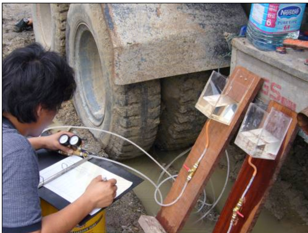
รูปที่ 3.35 การจดข้อมูลจาก เครื่องมือวัดแรงดัน (Pressure) ในดิน และ เกจวัดระยะการทรุดตัว(Dial Gauge)
