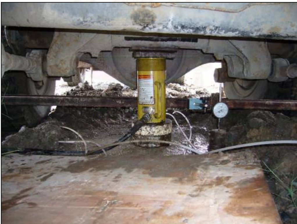
รูปที่ 3.34 การติดตั้งแม่แรงไฮดรอลิก (Hydraulic Jack) และเกจวัดระยะขยับตัว (Dial Gauge)
