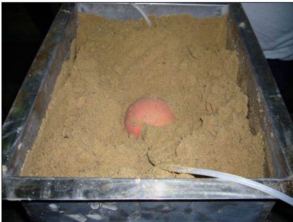
รูป 3.4 ใส່ทรายหยาบลงในถัง แล้ว นำลูกบอลวัดแรงดัน ใส่น้ำในถังเหล็ก
