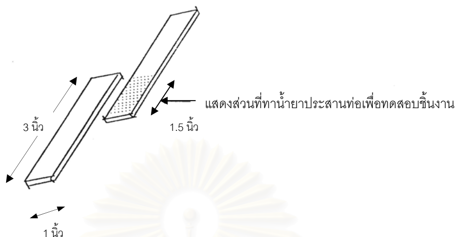
รูปที่ 4.4 แสดงวิธีการเตรียมชิ้นงานเพื่อทำการทดสอบแรงดึง (มาตรฐาน มอก.1032 (2534))
