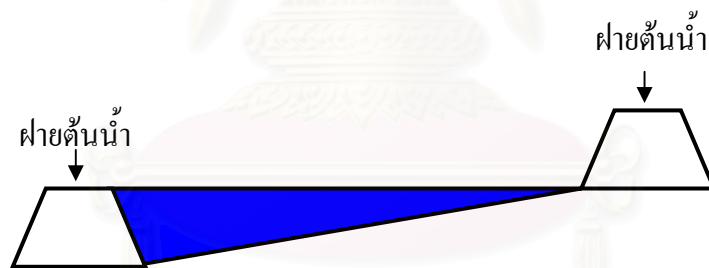
รูปที่ 4 - 12 แสดงตำแหน่งของฝายต้นน้ำที่สร้างแล้วมีประสิทธิภาพการเก็บกักน้ำสูงสุด
