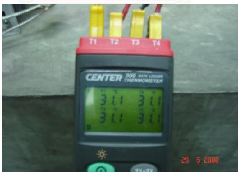
รูปที่ 410 คาต้าลอกเกอร์ที่ใช้บันทึกการกระจายอุณหภูมิของชิ้นทดลอง
