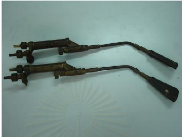
รูปที่ 47 หัวเผาควบคุมอุณหภูมิแบบ Air-LPG ที่ใช้ในการทดลอง
