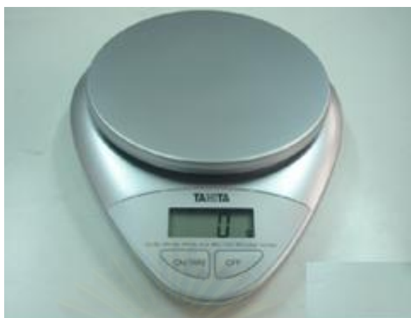
รูปที่ 49 เครื่องชั่งดิจิตอลวัดความเปลี่ยนแปลงน้ำหนักของถังแก๊ส LPG เพื่อกำหนดอัตราการไหลของแก๊ส
