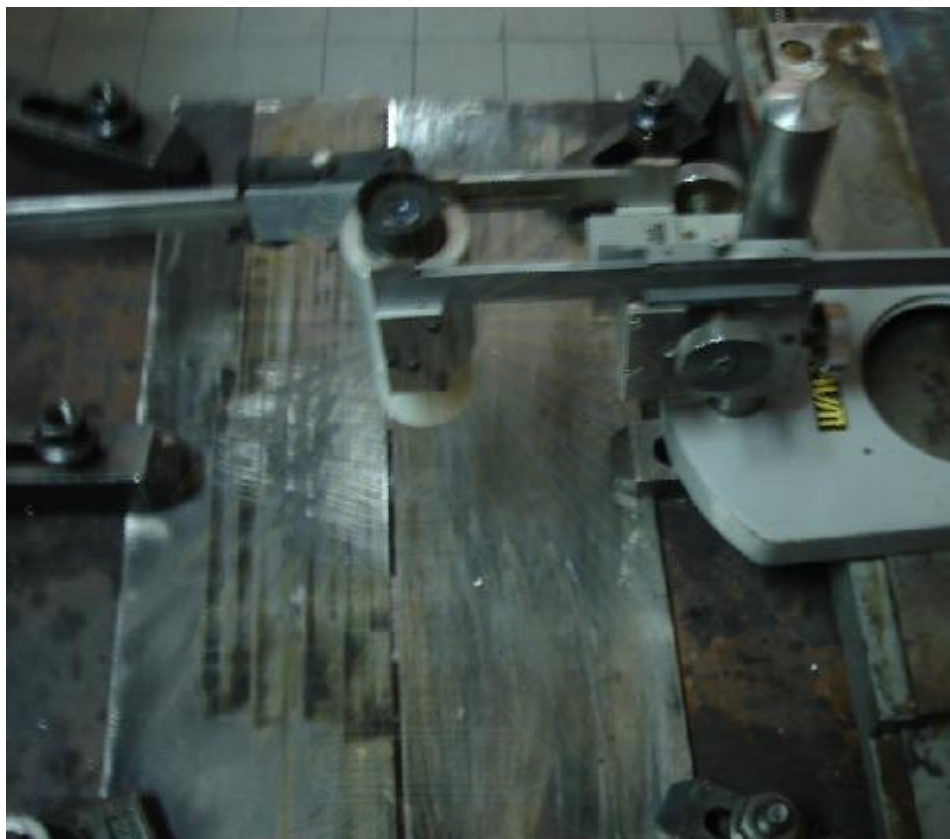
รูปที่ 44 การจับยึดชิ้นงานและกล้องวัดระยะการหดตัวตามขวางติดตั้งบน linear
