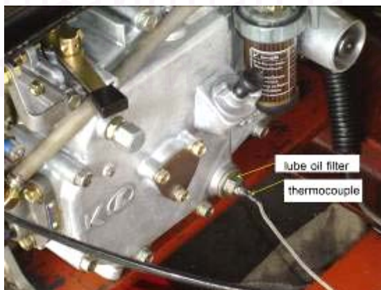
รูปที่ 5-10 แสดงการติดตั้งตำแหน่งของเทอร์โมคัปเปิลที่ตัวกรองน้ำมันหล่อลื่น
