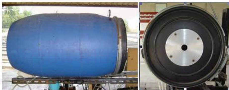
รูปที่ 5-12 แสดงถึงพักอากาศและการติดตั้ง Orifice Plate
