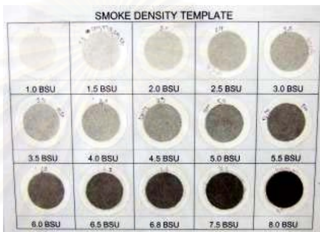
รูปที่ 5-18 แสดงตัวอย่างกระดาษกรองที่ใช้ในการวัดค่าควินด้าเปรียบเทียบกับ Bosch Unit Number
