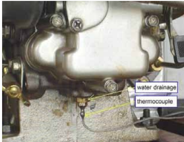
รูปที่ 5-11 แสดงตำแหน่งติดตั้งเทอร์โมคัปเปิลที่วาล์วถ่ายน้ำหล่อเย็นด้านล่างของฝาสูบ
