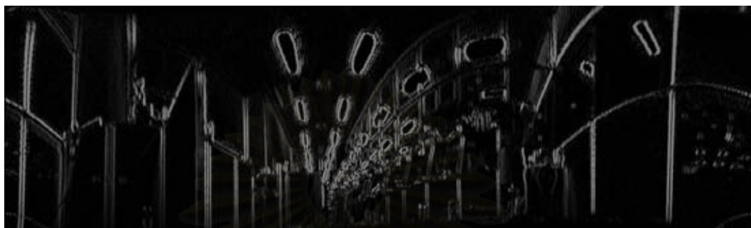
รูปที่ 4.4: ภาพขอบแนวตั้งที่เกิดจากขอบซ้ายและขวาของเส้นแนวตั้งในภาพ
