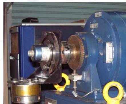
รูปที่ 4-16 Shaft Encoder ยี่ห้อ Cussons รุ่น P4503
