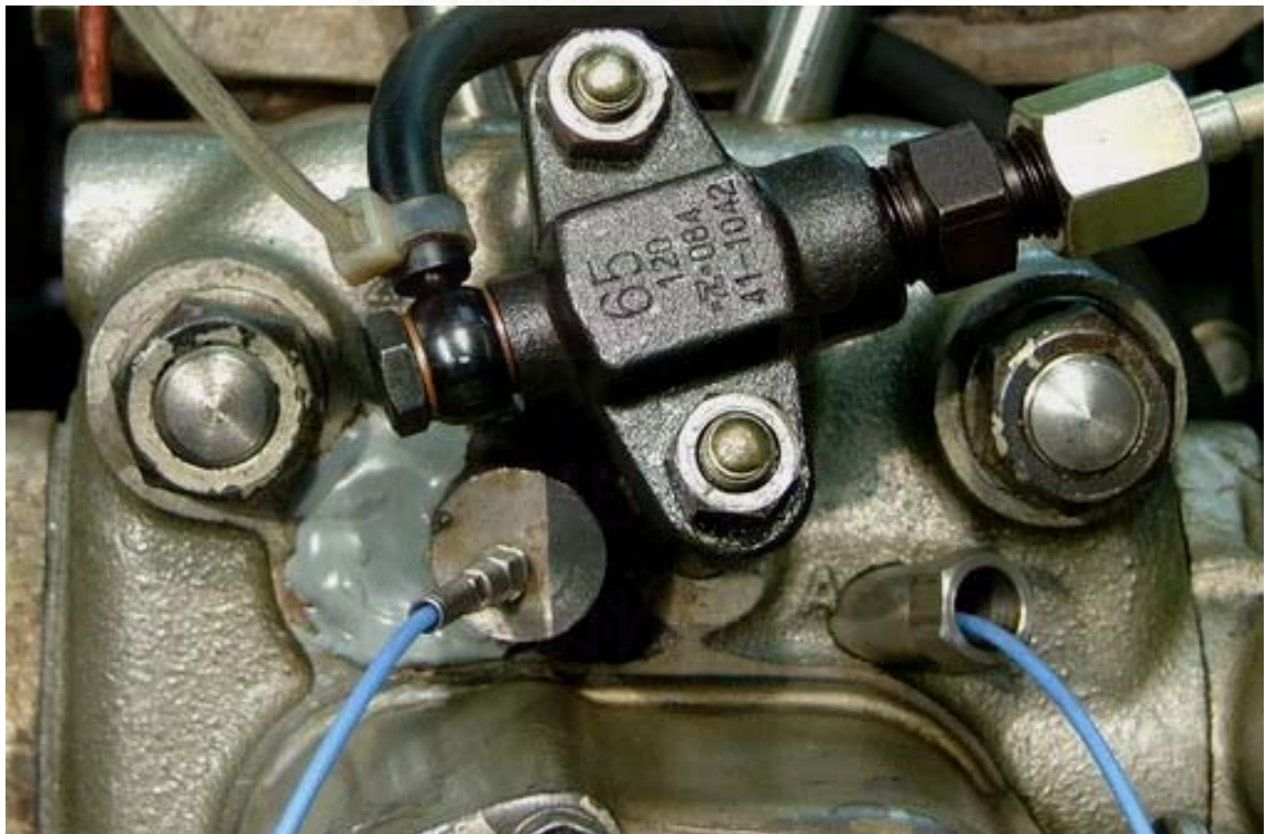
รูปที่ 5-4 แสดงฝาสูบที่ได้รับการดัดแปลงเพื่อติดตั้ง pressure transducer ที่ prechamber และ main chamber เรียบร้อยแล้ว
