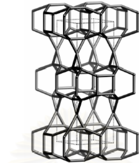
รูปที่ 2.12 ลักษณะโครงสร้างของ lovdarite [8]
