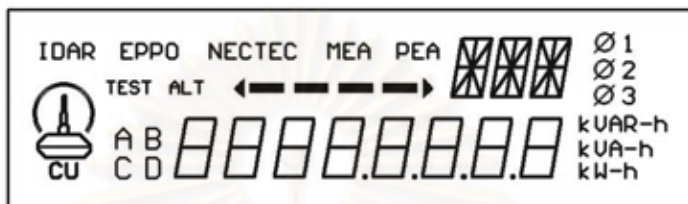
รูปที่ 3.4 ลักษณะหน้าจอดีแสดงผลของแอลซีดีที่ใช้
