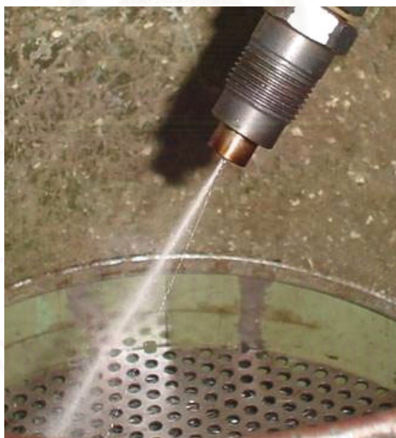
รูปที่ 5-39 แสดงสเปรย์น้ำมันที่มีลักษณะเป็นเส้นไม่ฟุ้งกระจาย
