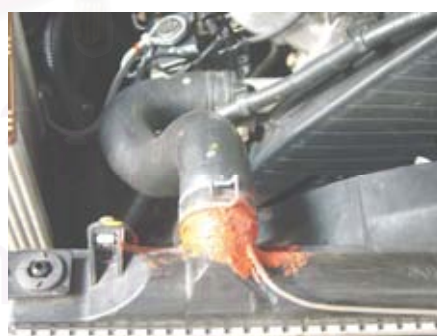
รูปที่ 3-9 แสดงตำแหน่งการวัดอุณหภูมิน้ำหล่อเย็นที่ทางออกเครื่องยนต์
