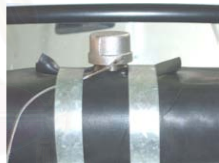
รูปที่ 3-15 แสดงตำแหน่งการวัดอุณหภูมิ ของอากาศภายนอก
