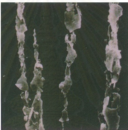
รูปที่ 2-27 แสดงอนุภาคการสึกหรอที่เกิดจากการเสียดสีกันของโลหะกับโลหะ [8]
