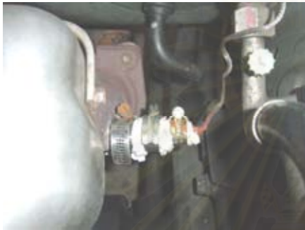
รูปที่ 3-12 แสดงตำแหน่งการวัดอุณหภูมิไอเสีย ของเครื่องยนต์
