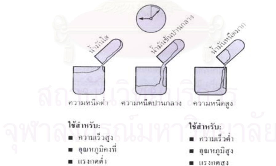
รูปที่ 2-23 ความหนืดของน้ำมันหล่อลื่นกับการใช้งาน [6]
