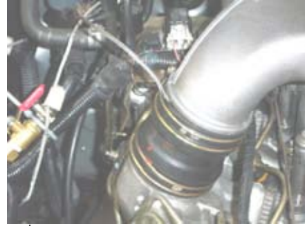
รูปที่ 3-11 แสดงตำแหน่งการวัดอุณหภูมิ ไอดีของเครื่องยนต์
