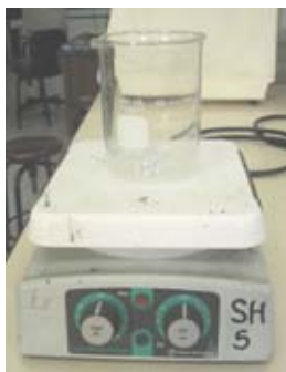
รูปที่ 3-2 แสดงเครื่องกวนที่ใช้ในการทดสอบ
