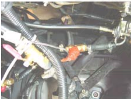
รูปที่ 3-14 แสดงตำแหน่งการวัดอุณหภูมิของ น้ำมันเชื้อเพลิงท่อไหลดักจับ
