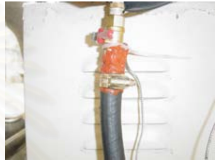
รูปที่ 3-13 แสดงตำแหน่งการวัดอุณหภูมิ น้ำมันเชื้อเพลิงที่ถังทดสอบ
