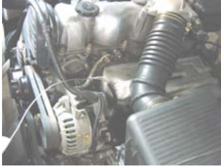
รูปที่ 3-10 แสดงตำแหน่งการวัดอุณหภูมิ น้ำมันหล่อลื่นของเครื่องยนต์
