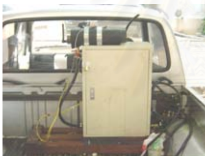
รูปที่ 3-6 แสดงอุปกรณ์ของระบบน้ำมันเชื้อเพลิงที่ติดตั้งเพิ่มเติมในรถยนต์ทดสอบ
