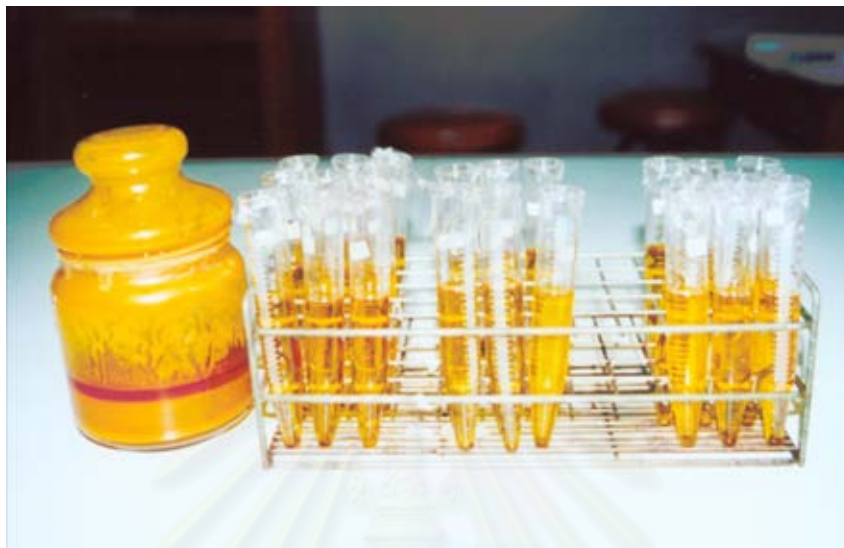
รูปที่ 3-4 แสดงน้ำมันปาล์มดิบผสมดีเซลที่ส่วนผสมต่างๆ หลังผ่านกระบวนการเหวี่ยงหนีศูนย์กลาง
