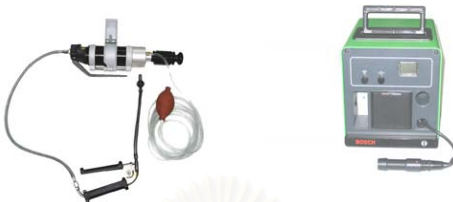
รูปที่ 3-26 ชุดเครื่องมือวัดค่าควันดำ ประกอบไปด้วยปั๊มดูดไอเสีย รุ่น ETD 020.00 (ซ้าย) เครื่องอ่านค่าควันดำ รุ่น ETD 020.50 (ขวา)
