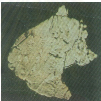
รูปที่ 2-30 แสดงอนุภาคการสึกหรอที่เกิดจากการล้าบนเฟือง (Gear Fatigue Particle) [8]
