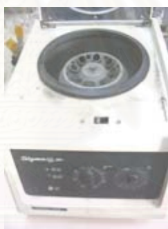
รูปที่ 3-3 แสดงเครื่องปั่นเหวี่ยงหนีศูนย์กลางที่ใช้ในการทดสอบ
