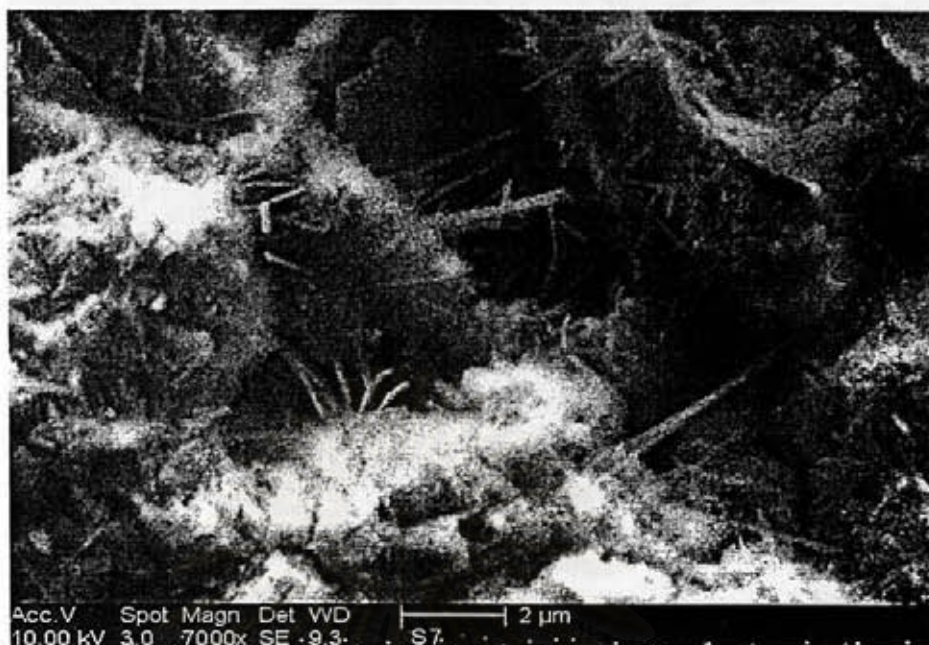
รูปที่ ค.1 ผลการศึกษา SEM ของซีเมนต์เพสต์ C18 อายุบ่ม 28 วัน กำลังขยาย 7000 เท่า
