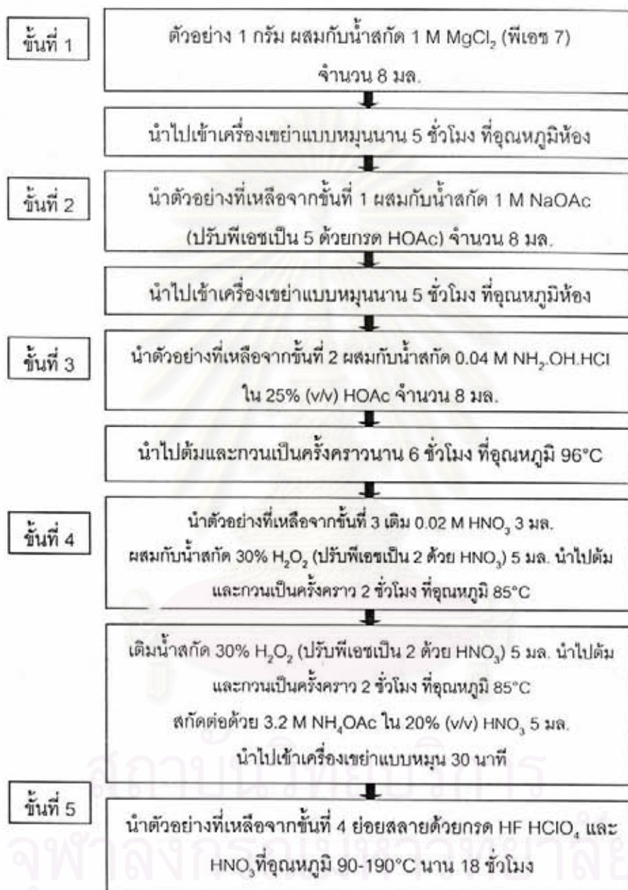
รูป 3.3 แผนผังแสดงขั้นตอนการสกัดด้วยวิธีสกัดแยกสารประกอบโลหะหนัก สรุปตารางการศึกษามวลของโลหะหนักในซีเมนต์เฟลด์ แสดงในตารางที่ 3.3
