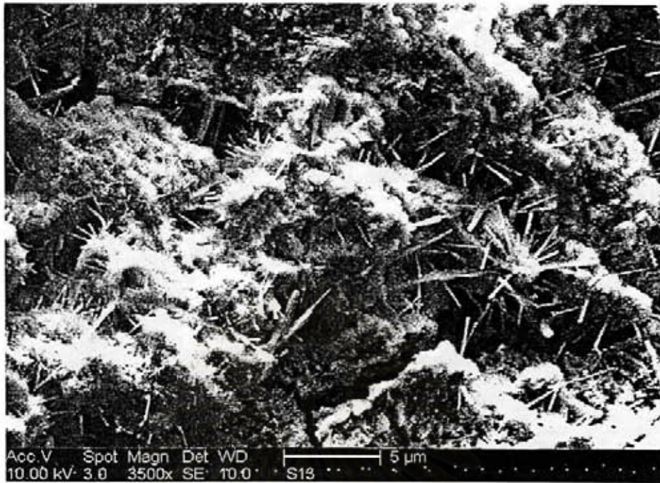
รูปที่ 4.13 ผลการศึกษา SEM ของซีเมนต์เพสต์ C32 อายุบ่ม 7 วัน ที่กำลังขยาย 3500 เท่า
