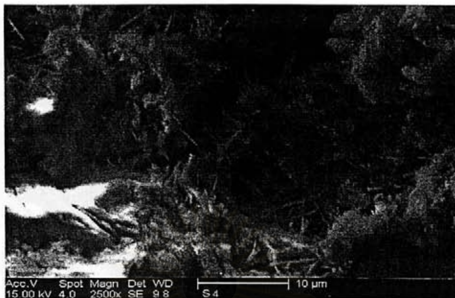
รูปที่ 4.7 ผลการศึกษา SEM ของซีเมนต์เพสต์ C0 อายุบ่ม 28 วัน ที่กำลังขยาย 2500 เท่า แสดงแคลเซียมซิลิเกตไฮเดรต
