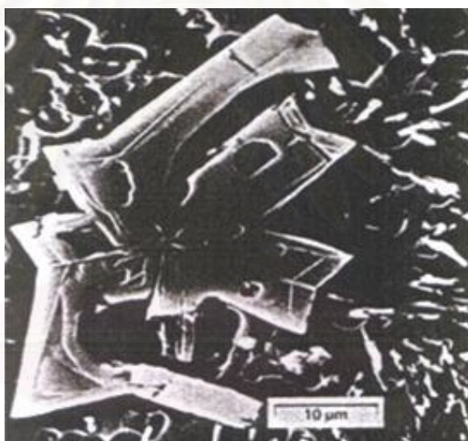
ภาพที่ 2.5 โครงสร้างจุลภาคของซิลิคอนปฐมภูมิที่เป็นรูปดาว (star-shaped)
