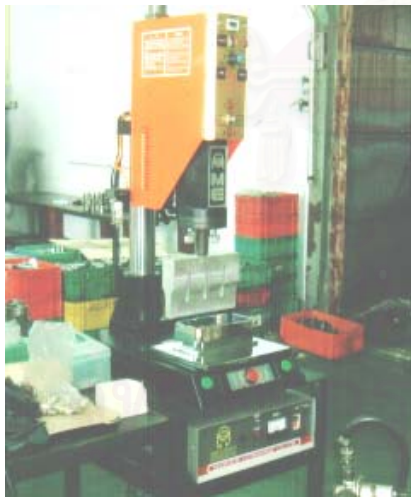
รูปที่ 3.14 เครื่องเชื่อมพลาสติก
