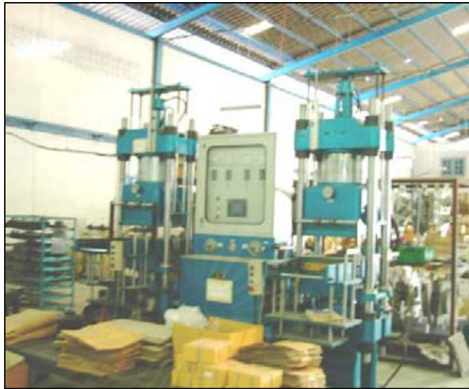
รูปที่ 3.13 เครื่องอัดยาง
