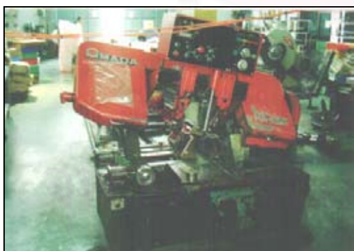
รูปที่ 3.5 เครื่องเลื่อยอัตโนมัติ
